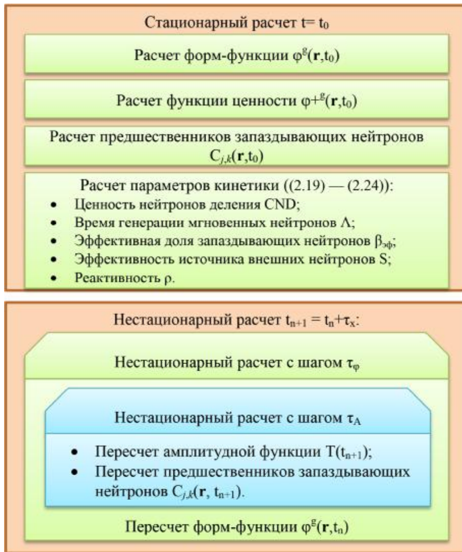
Рисунок 2. Упрощенная схема решения нестационарной задачи переноса нейтронов в улучшенном квазистатическом приближении
