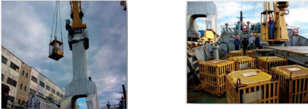
*Рис. 18 – Выгрузка РИТЭГ в специализированном порту*
