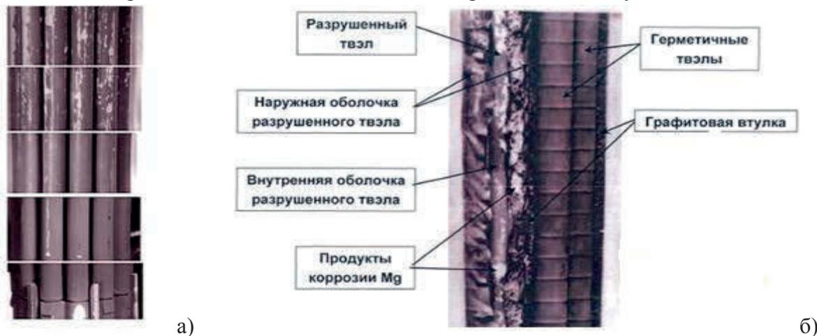
Рис. 3 – Коррозионные повреждения топлива РБМК (а) и аварийная ОТВС (б)
