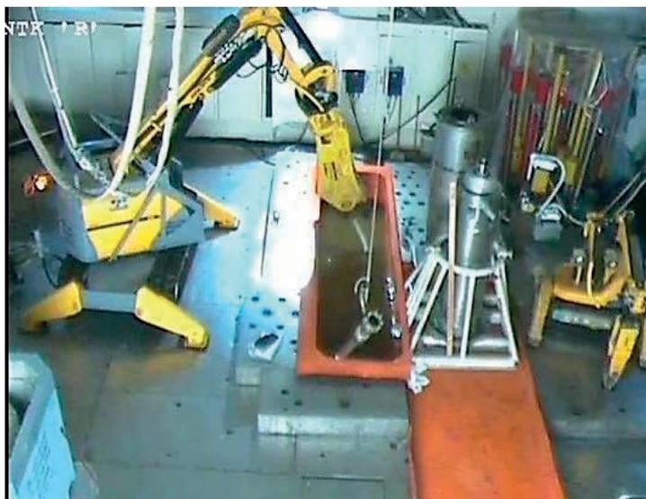
Рис. 4 – Процесс резки циркониевых каналов под водой
