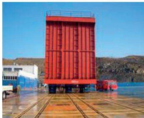
*Рис. 15 – Блок упаковка из носового и кормового хранилищ ТРО*
