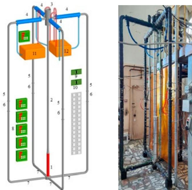
**Рис. 2.1.5** – Схема четырехпетлевого циркуляционного стенда для изучения естественной циркуляции и общий вид стенда. 1 – модель-имитатор ТВС; 2 – восходящая линия; 3 – верхний бак; 4 – теплообменники; 5 – нисходящие петли; 6 – участки для подключения измерительных систем; 7 – горизонтальные участки; 8 – измерители-регуляторы ТРМ-138; 9 – контроллеры; 10 – система управляемых реле; 11, 12 – баки с теплоносителем второго контура
