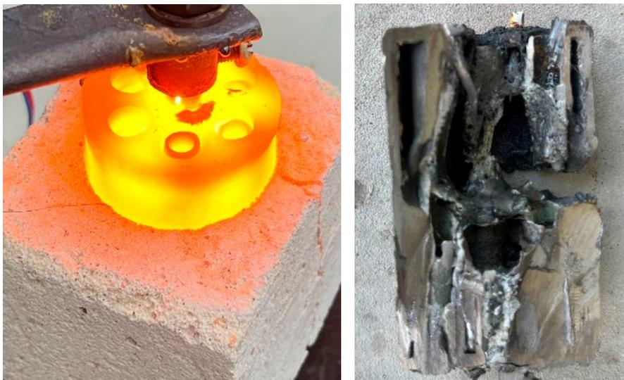
Рис. 2.1.4 — Вид рабочего участка 7-стержневой модели ТВС и финишного состояния верхнего торца ТВС
