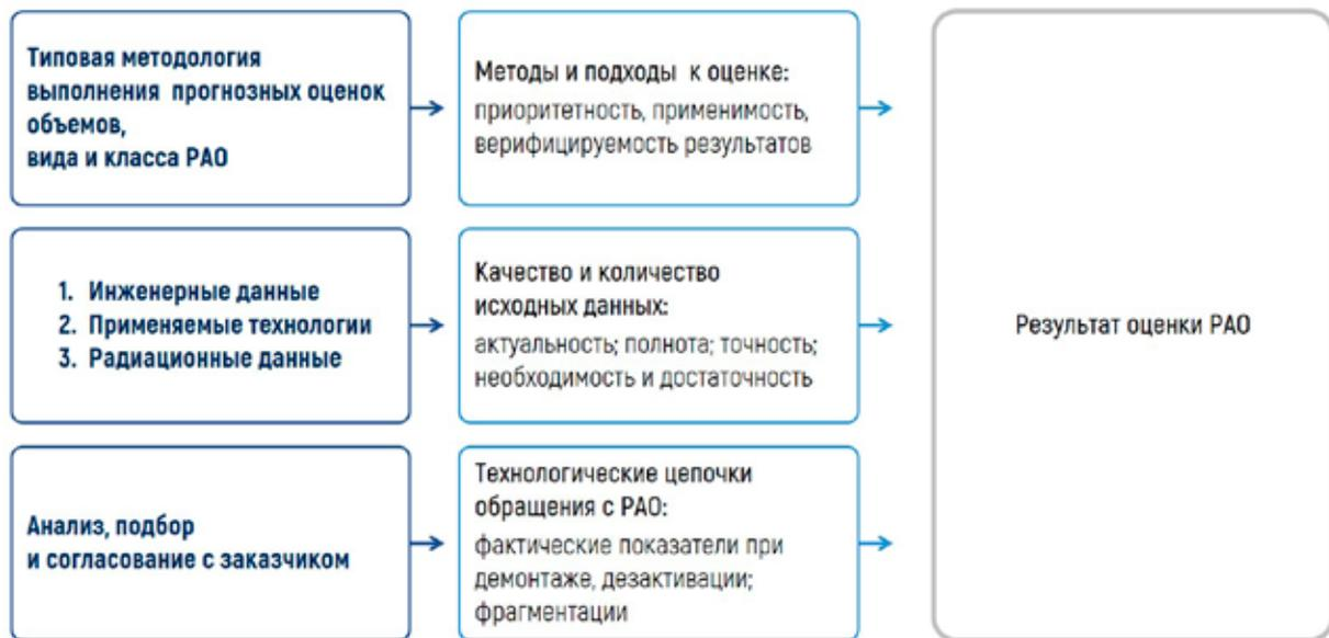
Рис. 2.2.5 – Блок-схема прогнозной оценки образования РАО от ВЭ энергоблоков АС
