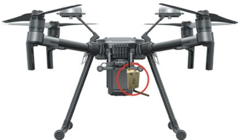
Рисунок 2.3.3 — Перспективный облик дозиметра на подвеске БПЛА
