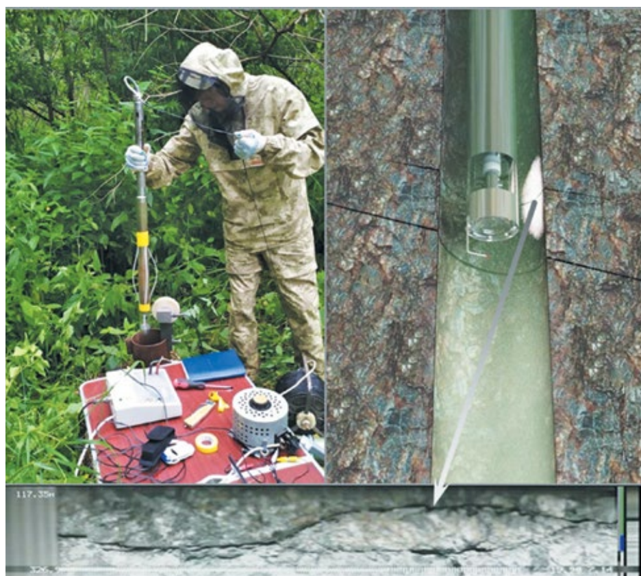
Рисунок 2.2.2 — Подготовка к проведению обследования при-скважинных зон массива в существующих глубоких скважинах и панорамное изображение участка массива. Результаты исследований были проинтерпретированы с применением полуавтоматических алгоритмов, позволяющих определить параметры трещиноватости массива — направление, раскрытие, углы падения и простираия трещин. Данная информация будет использована для уточнения геолого-структурной модели массива
