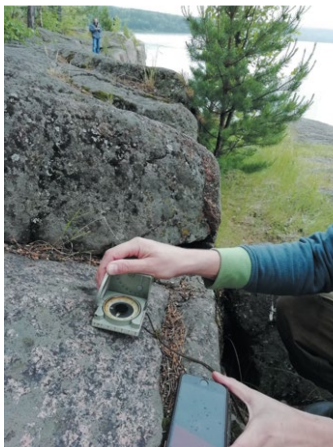
Рисунок 2.2.3 — Пример обследованного выхода коренных горных пород. Был выполнен отбор ориентированных образцов, проведено детальное изучение трещиноватости, а также изучение петрофизических свойств пород в камеральных условиях
