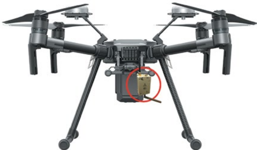
Рисунок 2.3.3 — Перспективный облик дозиметра на подвеске БПЛА
