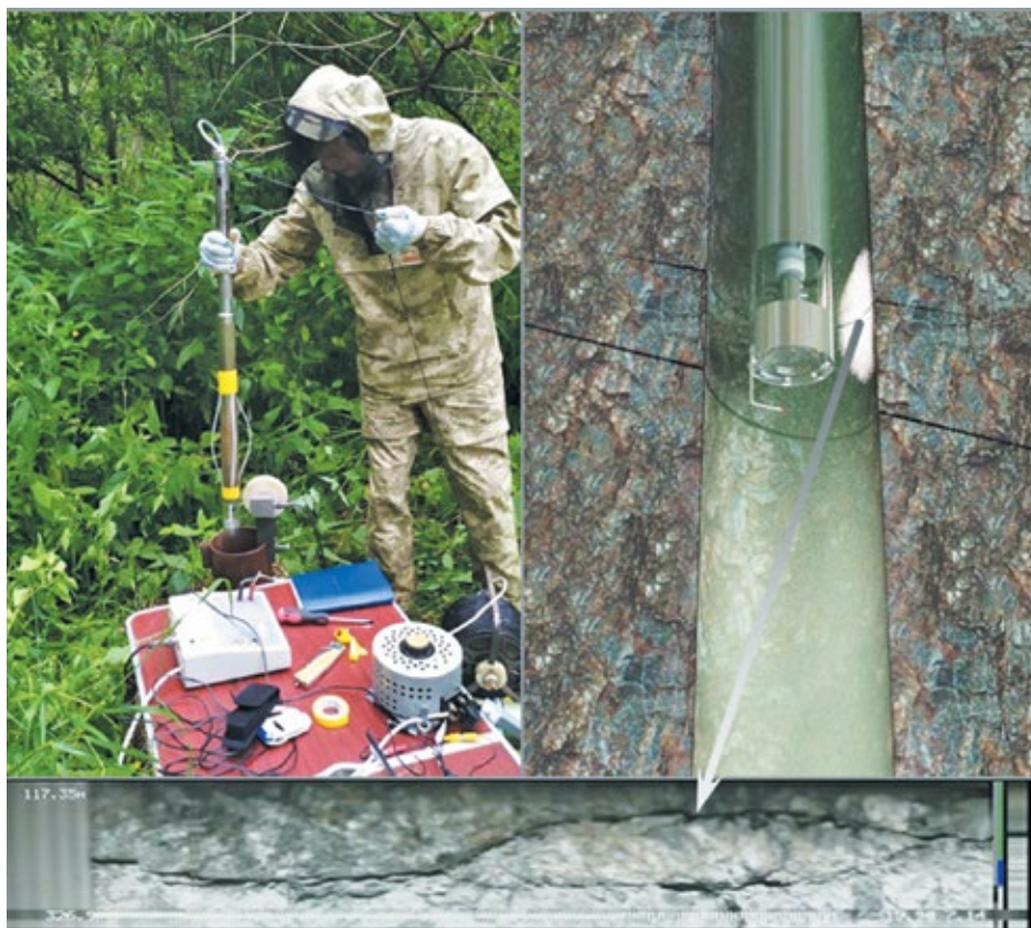
Рисунок 2.2.2 – Подготовка к проведению обследования при-скважинных зон массива в существующих глубоких скважинах и панорамное изображение участка массива. Результаты исследований были проинтерпретированы с применением полуавтоматических алгоритмов, позволяющих определить параметры трещиноватости массива — направление, раскрытие, углы падения и простираения трещин. Данная информация будет использована для уточнения геолого-структурной модели массива
