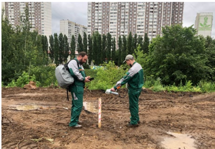
Рисунок 2.3.6 – Проведение сотрудниками ЦНТП ИБРАЭ РАН радиометрического обследования в районе сооружения участка Юго-Восточной хорды вблизи границ Московского завода полиметаллов
