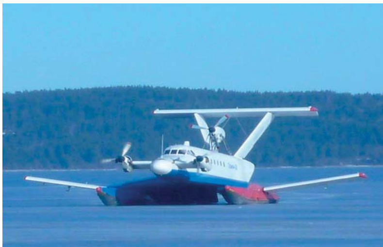
Рис. 5. Заводские испытания опытного образца экраноплана «Орион-20», март 2015 г.
