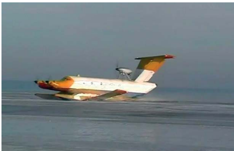
Рис. 6. Выход экраноплана «Орион-20» на поддуве из полыни. Февраль 2014 г.
