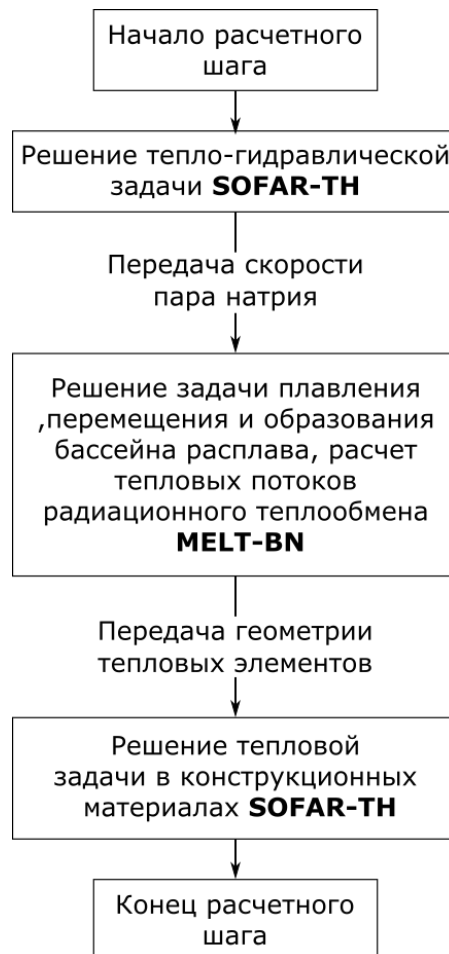
Рисунок 2.15 – Блок схема работы модуля MELT-BN в составе кода СОКРАТ-БН
