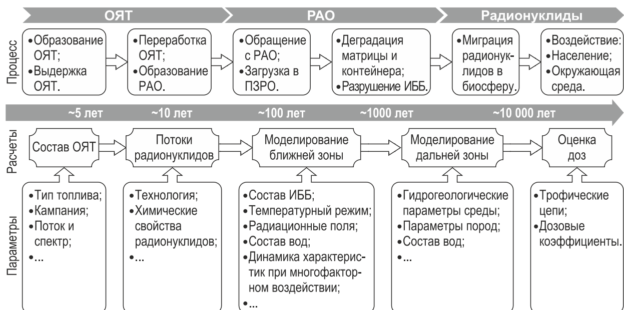
Рисунок 4.27 – Процессы, определяющие итоговую радиологическую значимость радионуклидов при захоронении РАО
