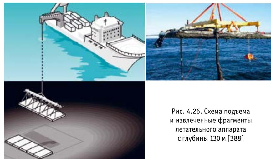
Рис. 4.26. Схема подъема и извлеченные фрагменты летательного аппарата с глубины 130 м [388]
