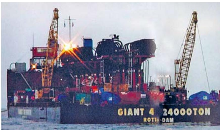
Рис. 4.54. Поддерживающая баржа «Гигант-4» с раскрепленной АПЛ «Курск»
