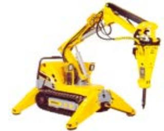
Рис. 4.72. Роботизированный комплекс Brokk 90 N
