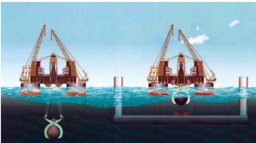
Рис. 4.45. Схема постановки затонувшей АПЛ в плавучий док в море
