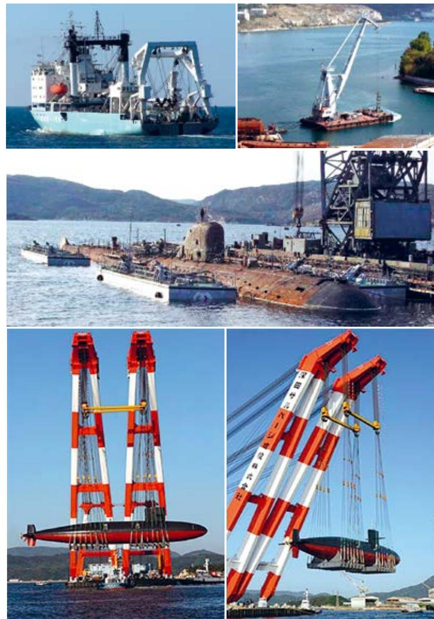
Рис. 4.19. Килектор и плавучие краны, используемые для подъема затонувших и крупногабаритных морских объектов [117; 116]
