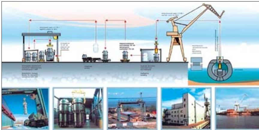
Рис. 4.63. Принципиальная схема выгрузки ОЯТ из реакторов АПЛ береговым комплексом выгрузки «ЦС "Звездочка"» в г. Северодвинске
