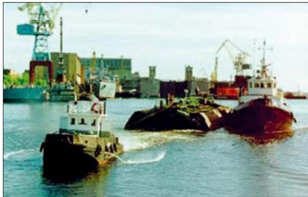
Рис. 4.79. Буксировка блока реакторного отсека
