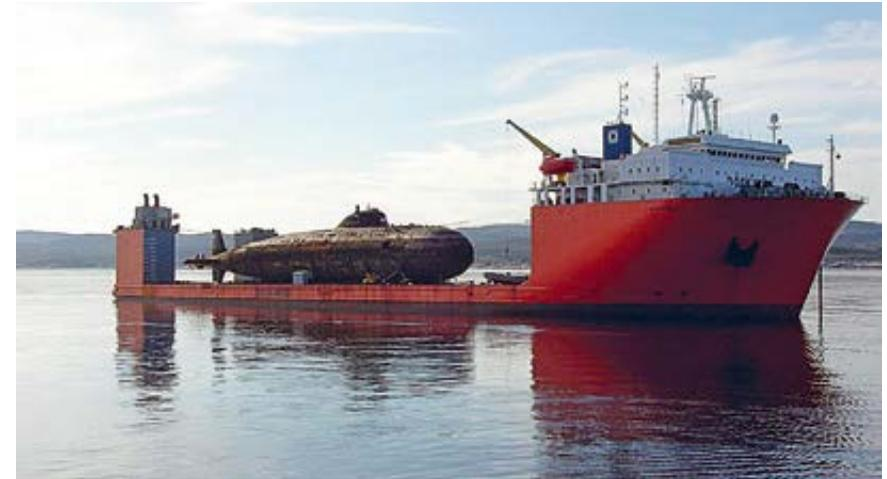
Рис. 4.60. СБГ с АПЛ на борту снимается с якоря
