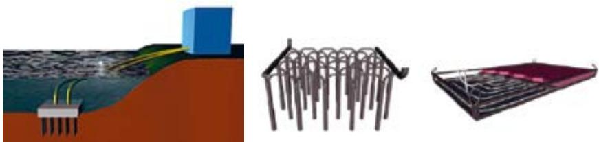
Рис. 4.25. Кривоустановка с вертикальной и плоской замораживающими ячейками [388]
