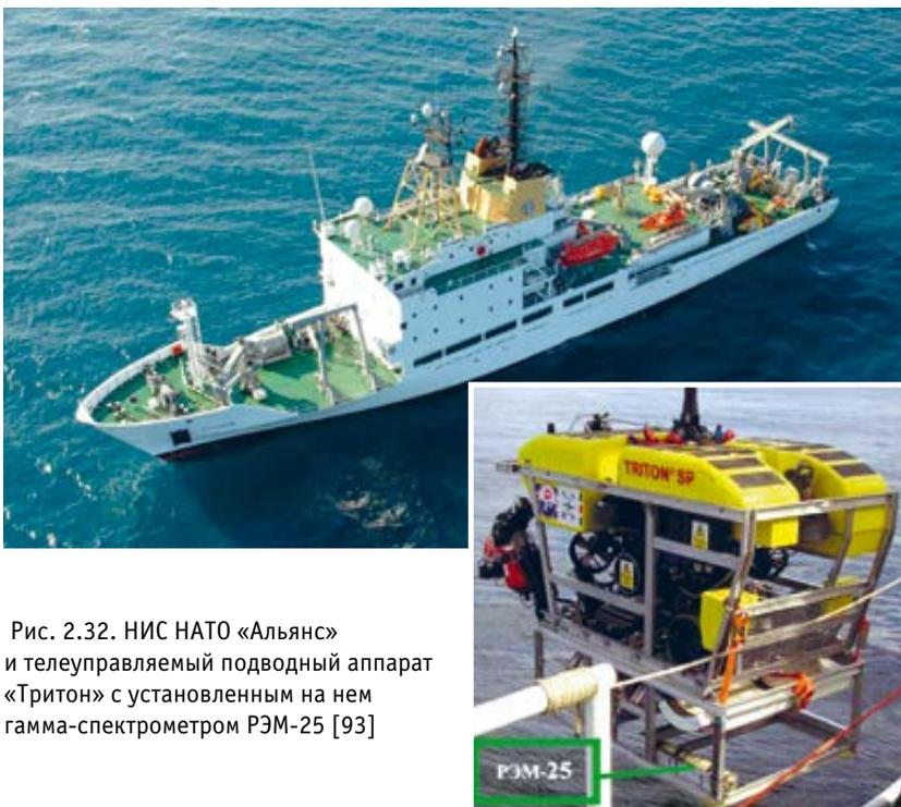
Рис. 2.32. НИС НАТО «Альянс» и телеуправляемый подводный аппарат «Тритон» с установленным на нем гамма-спектрометром РЭМ-25 [93]
