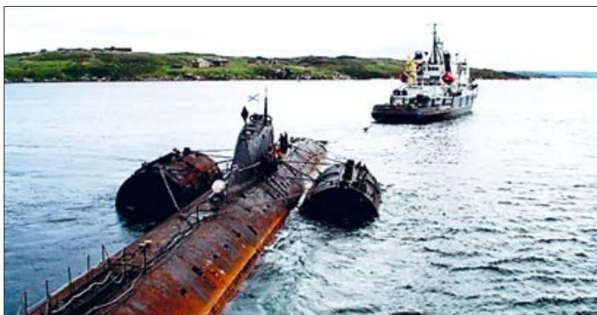
Рис. 4.52. АПЛ, оборудованная судоподъемными понтонами
