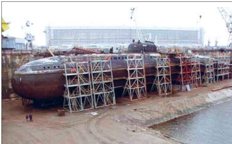
Рис. 5.5. Утилизация АПЛ в док-камере
