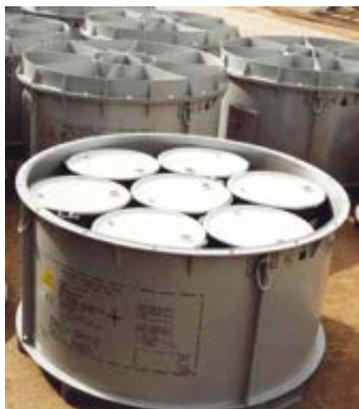
Рис. 5.32. Сертифицированный контейнер для транспортировки и долговременного хранения ТРО низкой активности
