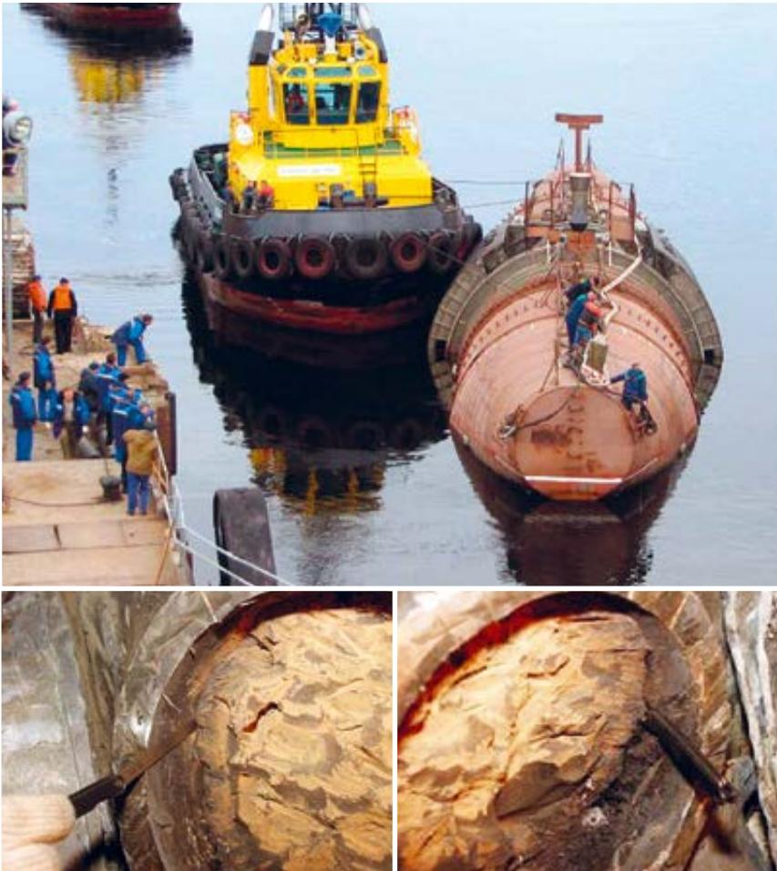
Рис. 1.28. Вид реакторного отсека АПЛ заказа № 900 и неплотности прилегания консерванта к внутренним поверхностям трубопровода первого контура, образовавшиеся в течение 30 лет, после заполнения фурфуролом входной камеры реактора
