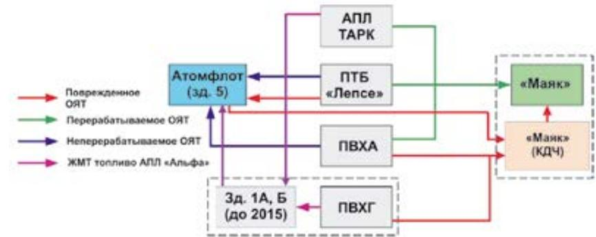
Рис. 5.11. Структурно-функциональная схема обращения с ОЯТ на Северо-Западе России [261]: ТАКР — тяжелый атомный ракетный крейсер, ПТБ — плавучая техническая база, ПВХА — пункт временного хранения ОЯТ и РАО в бухте Андреева, ПВХГ — пункт временного хранения ОЯТ и РАО «Гремиха», КДЧ — камера дефектных чехлов
