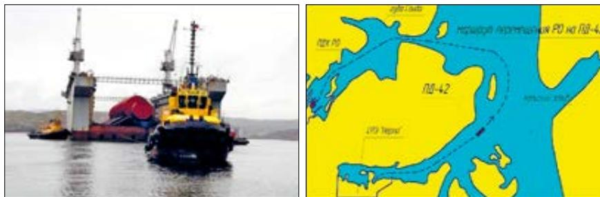
Рис. 4.80. Перевод блоков РО с СПЗ «Нерпа» в пункт длительного хранения
