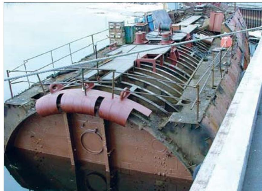
Рис. 5.3. Трехотсечный реакторный блок
