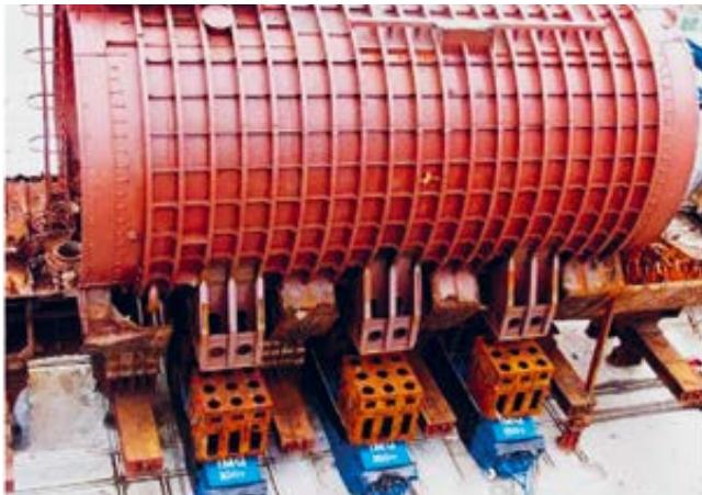
Рис. 5.37. Одноотсечный реакторный отсек, подготовленный к длительному хранению
