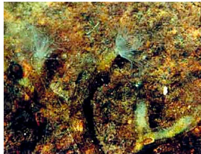
Рис. 3.12. Поверхность металла, обросшая морскими организмами
