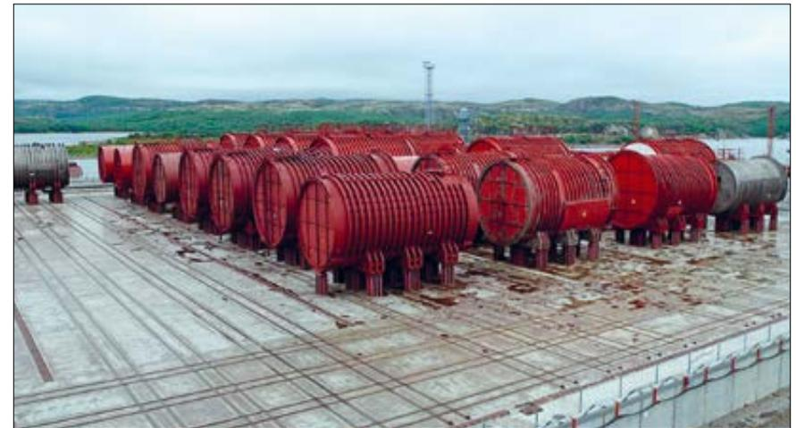
Рис. 5.40. Внешний вид площадки и реакторных отсеков утилизированных АПЛ, установленных на длительное хранение в губе Сайда
