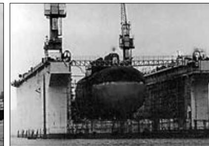
Рис. 4.43. Подготовка и транспортировка АПЛ в плавучем доке
