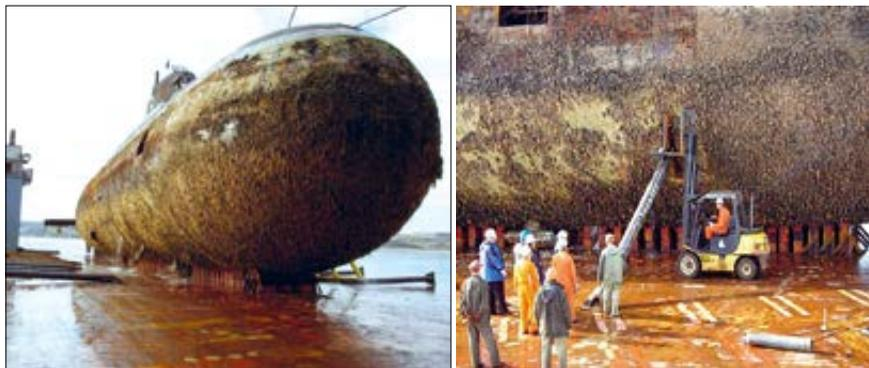
Рис. 4.59. Раскрепление АПЛ на палубе СБГ, контроль радиационной обстановки
