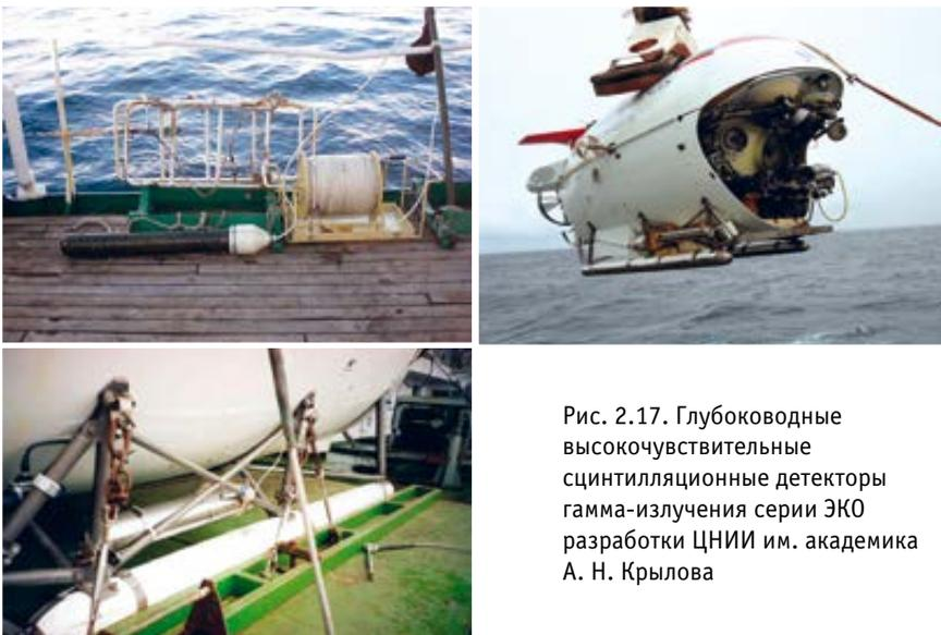
Рис. 2.17. Глубоководные высокочувствительные сцинтилляционные детекторы гамма-излучения серии ЭКО разработки ЦНИИ им. академика А. Н. Крылова
