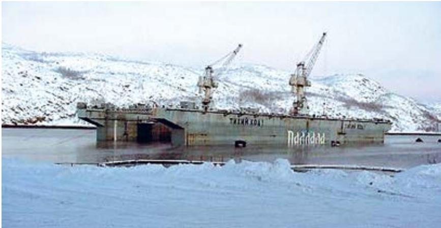
Рис. 5.10. Притопленный для приема реакторных блоков передаточный док ПД-42 «Паллада» с реакторными отсеками внутри
