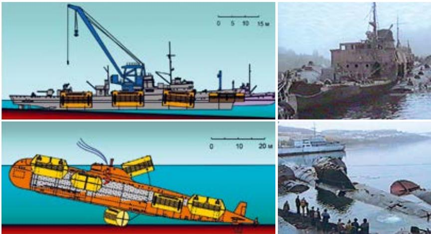
Рис. 4.20. Подъем с помощью понтонов надводного корабля и подводной лодки [116]
