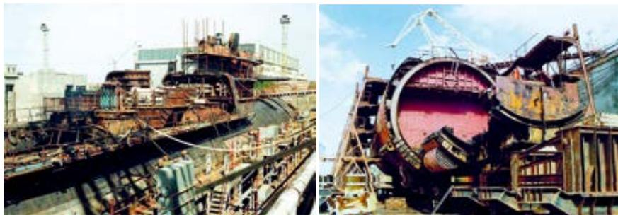
Рис. 5.8. Разделка корпуса АПЛ на ПО «Севмашпредприятии»
