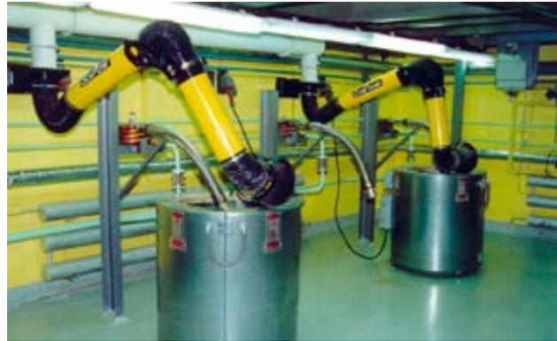
Рис. 5.30. Установка для выпаривания ЖРО
