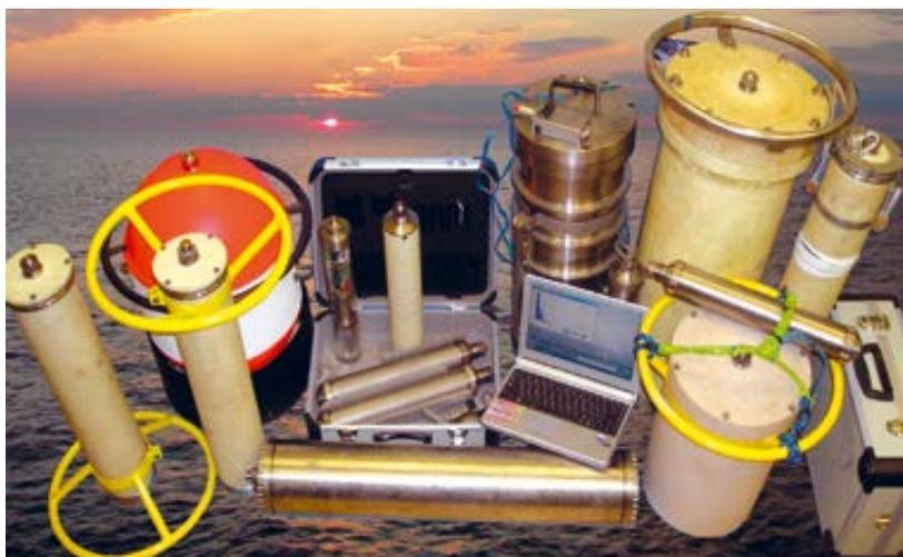
Рис. 2.14. Глубоководные высокочувствительные сцинтилляционные детекторы гамма-излучения серии РЭМ разработки РНЦ «Курчатовский институт»
