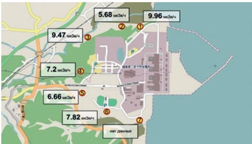
Рис. 10. Мощность дозы на датчиках стационарного контроля по периметру площадки АЭС «Фукусима-2» на 27 марта, 11 часов местного времени
