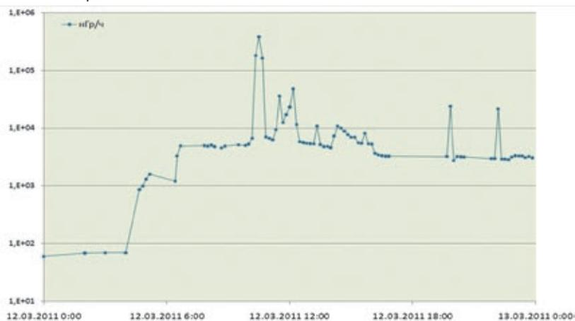
Рис. 11. Динамика мощности дозы на промплощадке (главные ворота АЭС) с начала останова реакторов до 13 марта, нГр/ч
