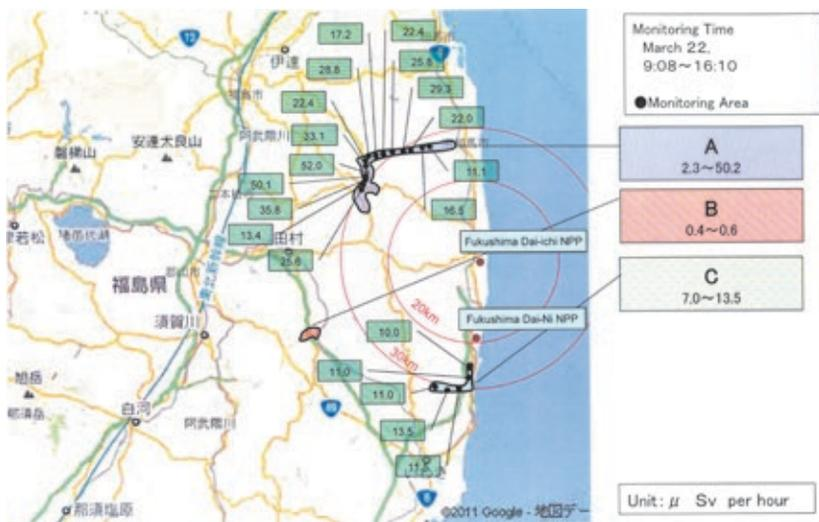
Рис. 13. Точки измерения мощности дозы (мкЗв/ч) с целью уточнения осевых значений на северо-западном и южном следах
