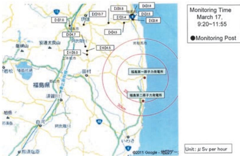
Рис. 9. Точки контроля и значения мощности дозы ( $\text{мкЗв/ч}$ ), полученные с помощью передвижных лабораторий на север от АЭС
