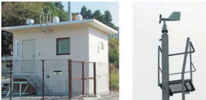
Рис. 7. Датчики контроля за радиационной обстановкой в рамках системы SPEEDI
