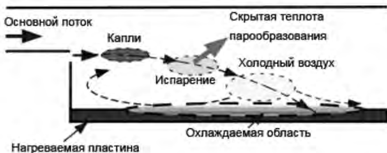
Рис. 2. Схема отрывного двухфазного течения в [51]
