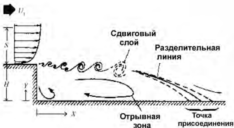
Рис. 1. Структура отрывного течения за обратным уступом
