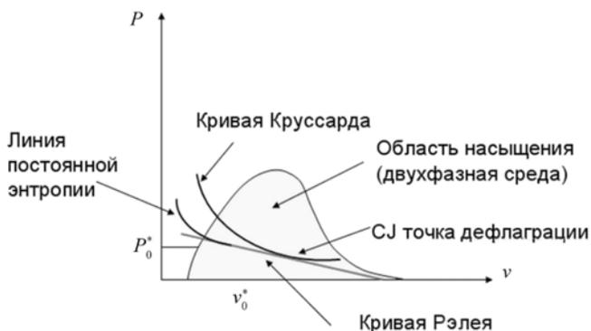
Рис. 4.4. Кривая насыщения и линия Рэлея для перегретой жидкости с начальным состоянием  $(P_0^*, v_0^*)$
