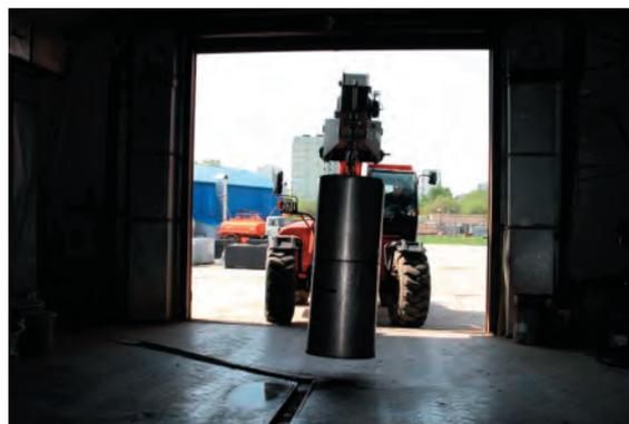
Рис. 4.5.4.9. Транспортировка свинцового перегрузочного контейнера в хранилище №7
