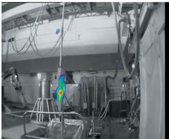
Рис. 4.5.4.5. Гамма-изображение бериллиевого блока, полученное «Гаммавизором»
