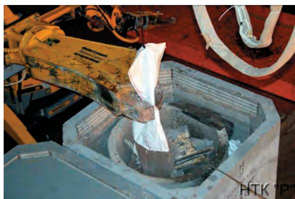
Рис. 4.5.4.10. Фрагментация высокоактивных бериллиевых блоков с загрузкой в контейнеры НЗК-150-1.5П
