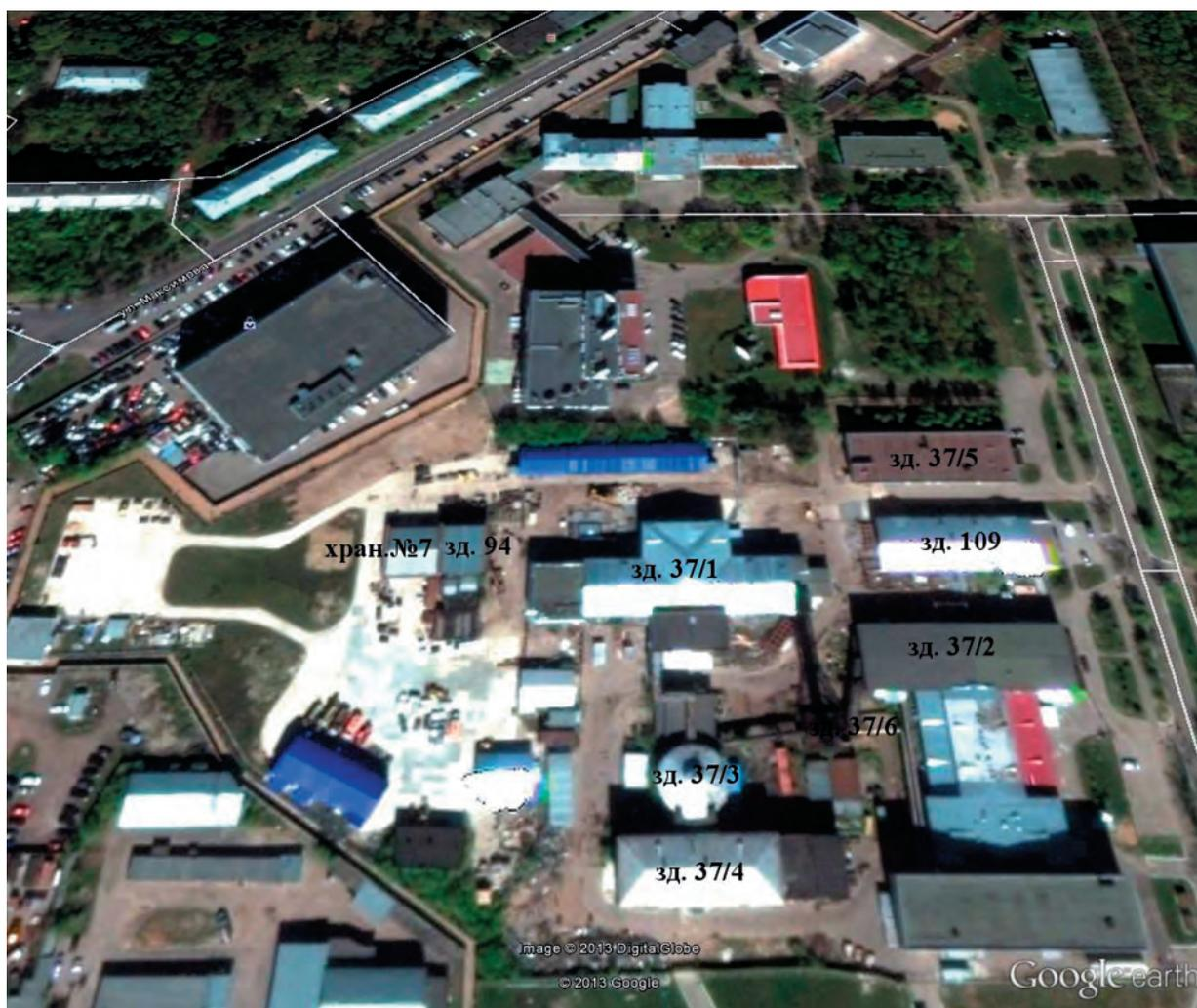
Рис. 4.5.1.3. Схема расположения производственных зданий и сооружений на площадке реактора МР
