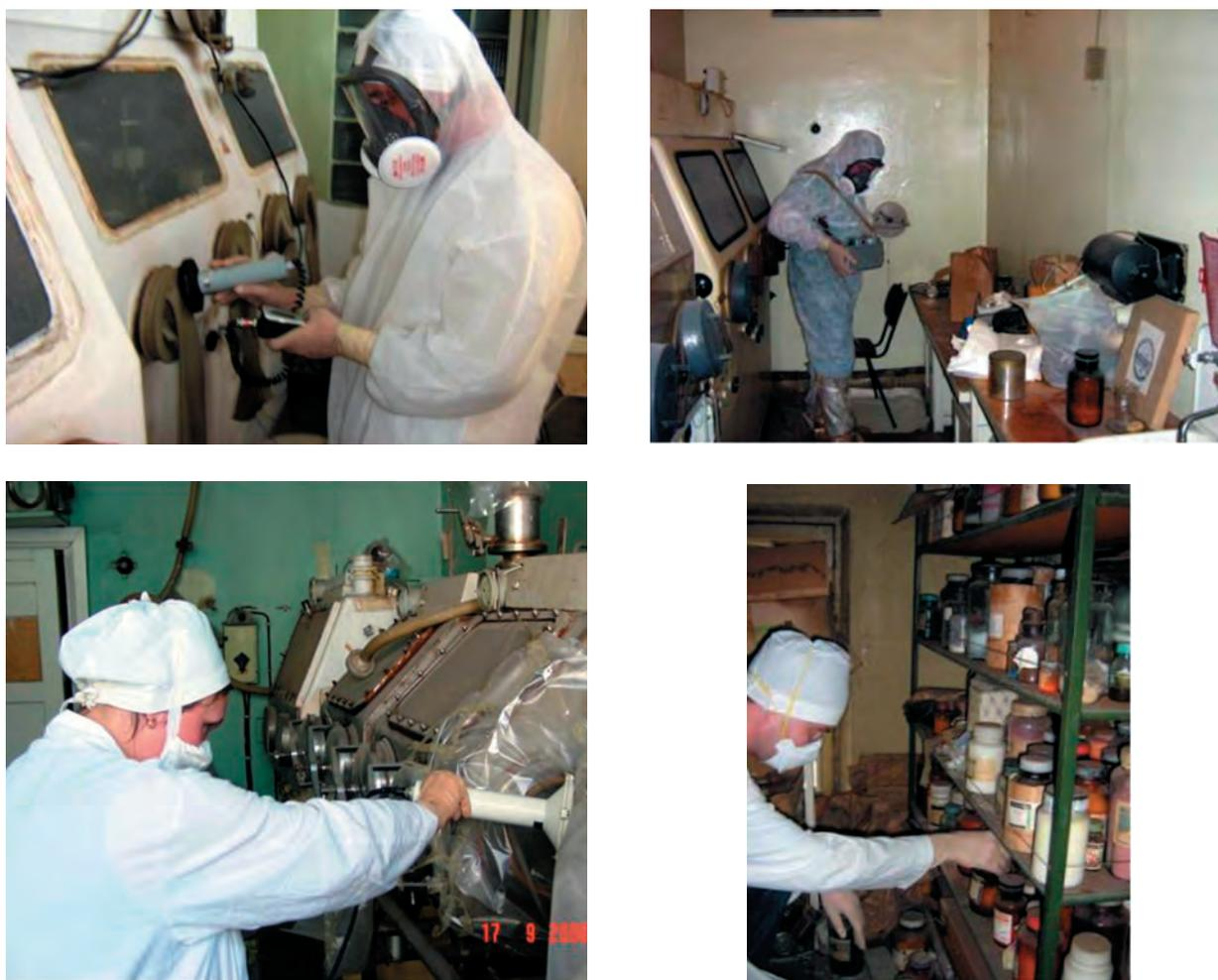
Рис. 3.3.3. Выполнение работ по радиационному обследованию лабораторных помещений в корпусе «Б»
