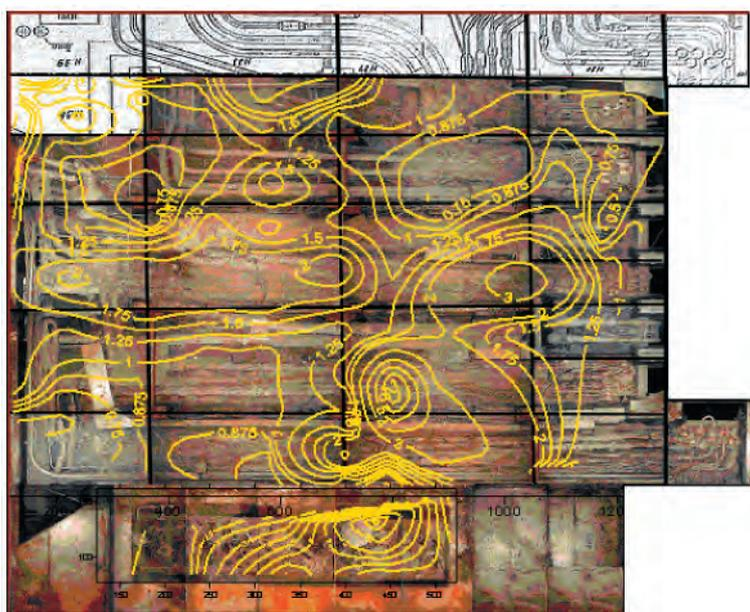
Рис. 4.5.3.3. Картограмма мощностей  $\gamma$ -излучения в поднастильном пространстве (значения мощности дозы на изолиниях даны в мЗв/ч)
