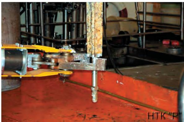
Рис. 4.5.4.7. Отделение алюминиевого хвостовика бериллиевого блока
