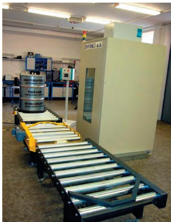
Рис.3.3.4. Участок сбора и контейнеризации ТРО в корпусе «Б» ВНИИНМ
