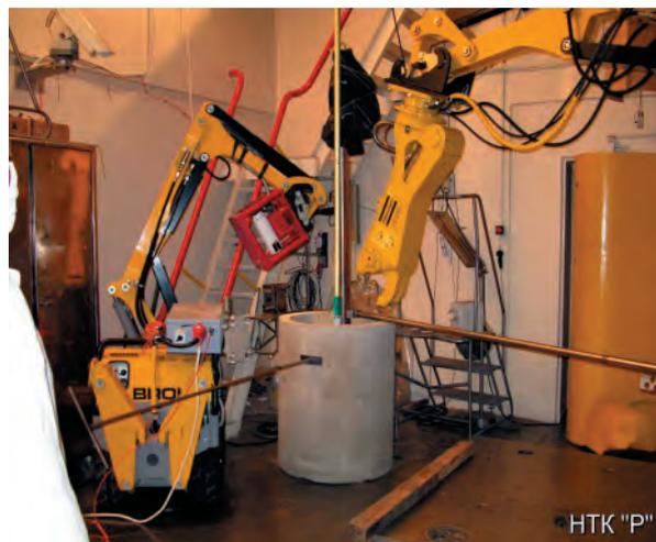
*Рис. 4.5.3.12. Технология резки канала со сборкой, установленной над горловиной транспортного люка камеры резки*
