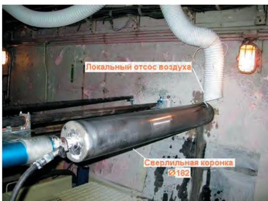
Рис. 4.5.3.6. Установка алмазного бурения
