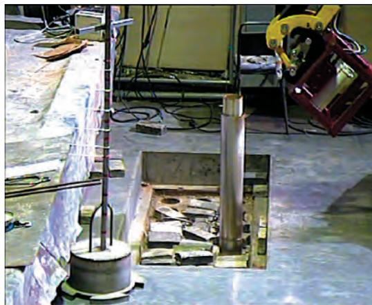
Рис. 4.5.3.17. Обследование содержимого ячеек хранилища СУЗ с помощью измерительного комплекса «Гамма-пионер»
