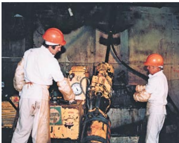
Рис. 3.4. Подготовка бурового станка к работе
