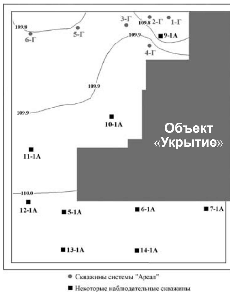
Рис. 9.5. Схема расположения скважин «Ареал» и ряда других скважин ЧАЭС около объекта «Укрытие». Приведены абсолютные отметки уровней воды на сентябрь 1995 г.
