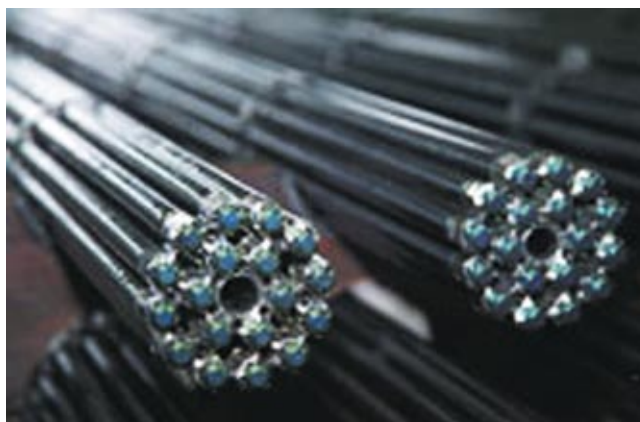
Рис. 1.3. Тепловыделяющие сборки РБМК-1000
