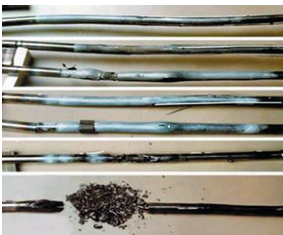
Рис. 5.1. Изменение формы и последовательное разрушение ТВЭЛов при испытаниях на импульсном реакторе (при возрастающей величине нейтронного импульса)
