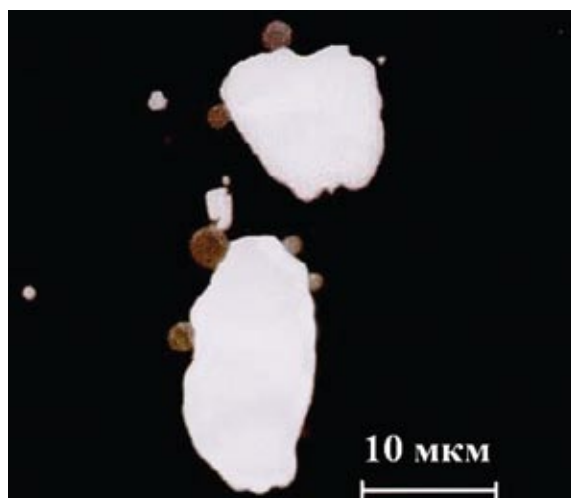
Рис. 6.23. Поверхность черной лавы. Видны крупные включения оксидов урана (белый цвет) и небольшие глобулы нержавеющей стали (серо-коричневый цвет)
