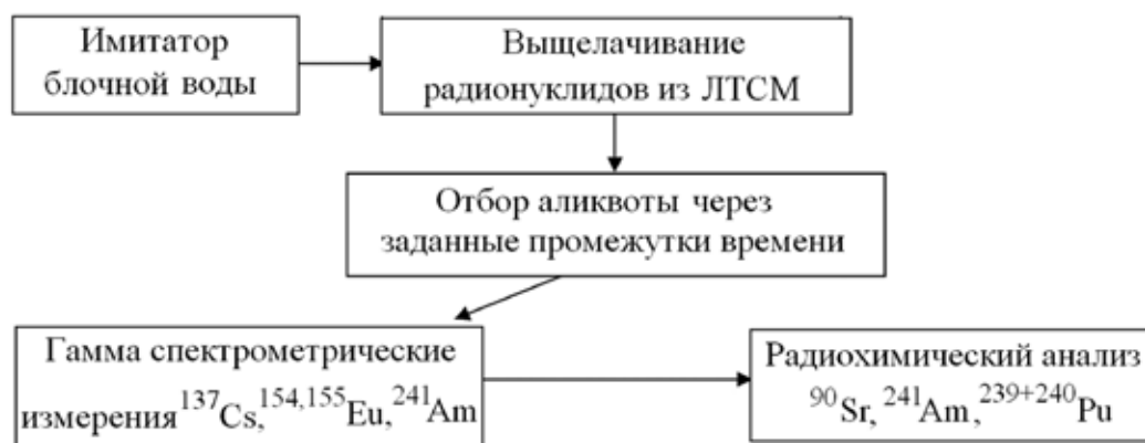
Рис. 11.5. Схема проведения экспериментов с имитатором блочной воды
