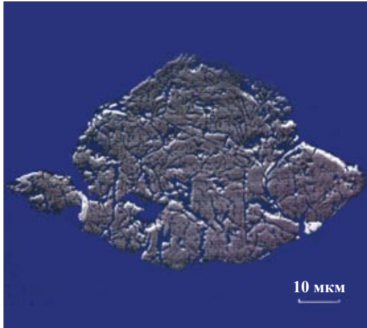
Рис. 5.6. Полированный препарат «горячей частицы» в виде оксида циркония с включениями фазы (Zr,U)O_x (белые участки)
