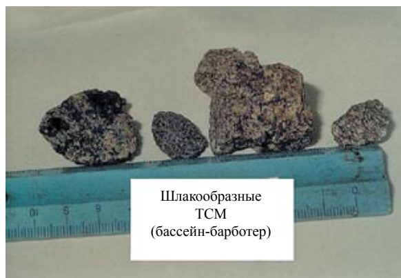
Рис. 6.10. «Шлак», или шлакообразные гранулированные ЛТСМ
