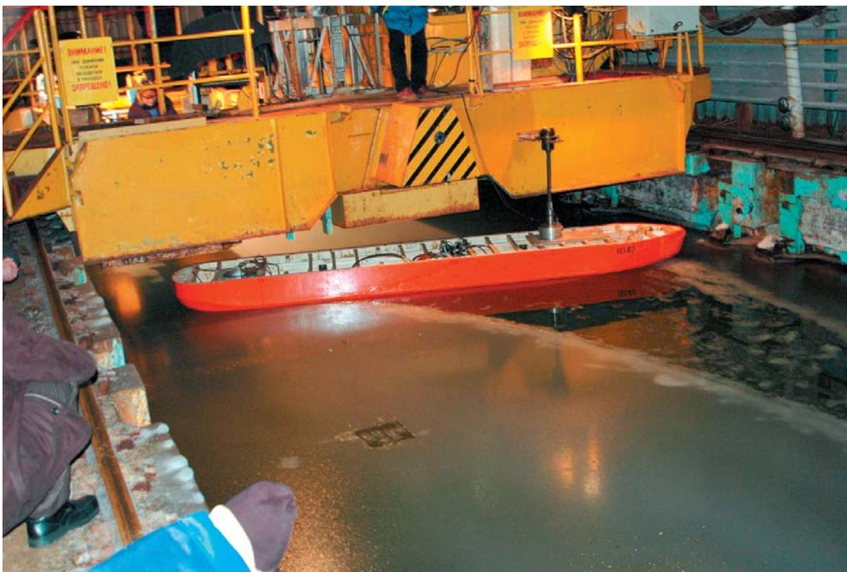
Рис. 7. Пассивный разворот турельного судна под действием дрейфующего льда
