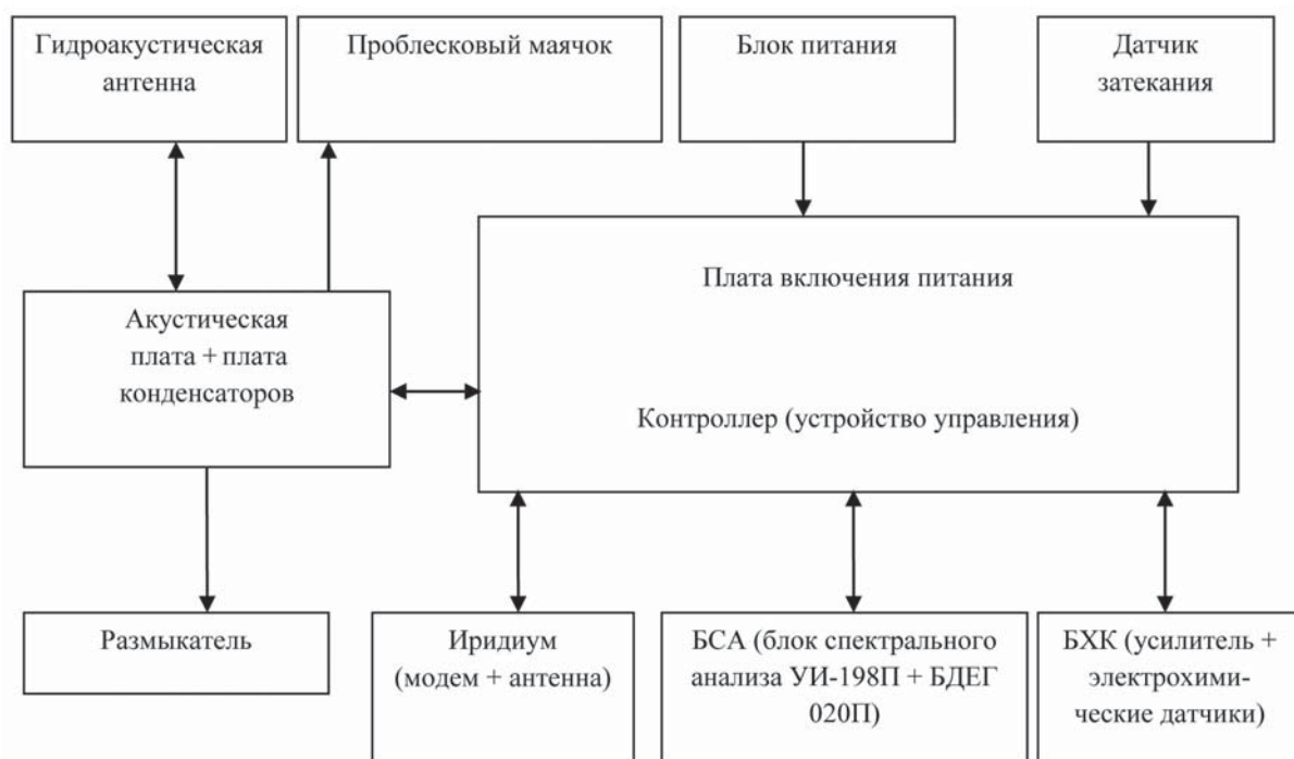
Рис. 4. Блок-схема автономной донной станции
