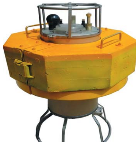
Рис. 3. Автономная донная станция
