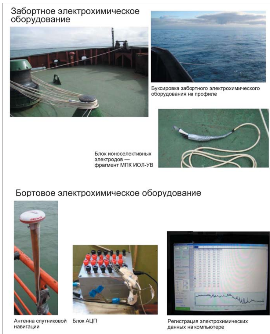
Рис. 8. Заборное и бортовое оборудование комплекса ИОЛ-УВ
