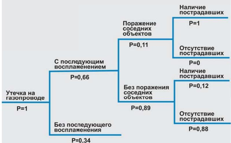
Рис. 7. Дерево событий при утечке газа на газопроводе при низких температурах эксплуатации
