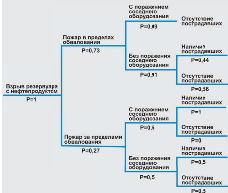
Рис. 9. Дерево событий при взрыве резервуара с нефтепродуктом при низких температурах эксплуатации
