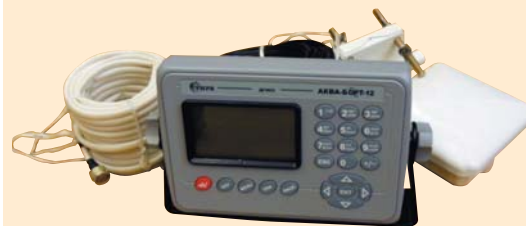
Рис. 7. 16-канальный ГЛОНАСС/GPS-приемник «Аква-борт-12», предназначенный для использования в морском и речном судоходстве (РИРВ)
