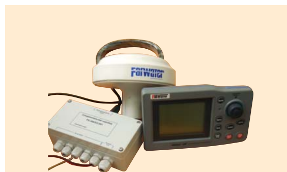
Рис. 2. Судовой приемоиндикатор ГНСС ГЛОНАСС/GPS со встроенным приемником дифференциальной поправки РК-2006мк2 («Радио Комплекс»)
