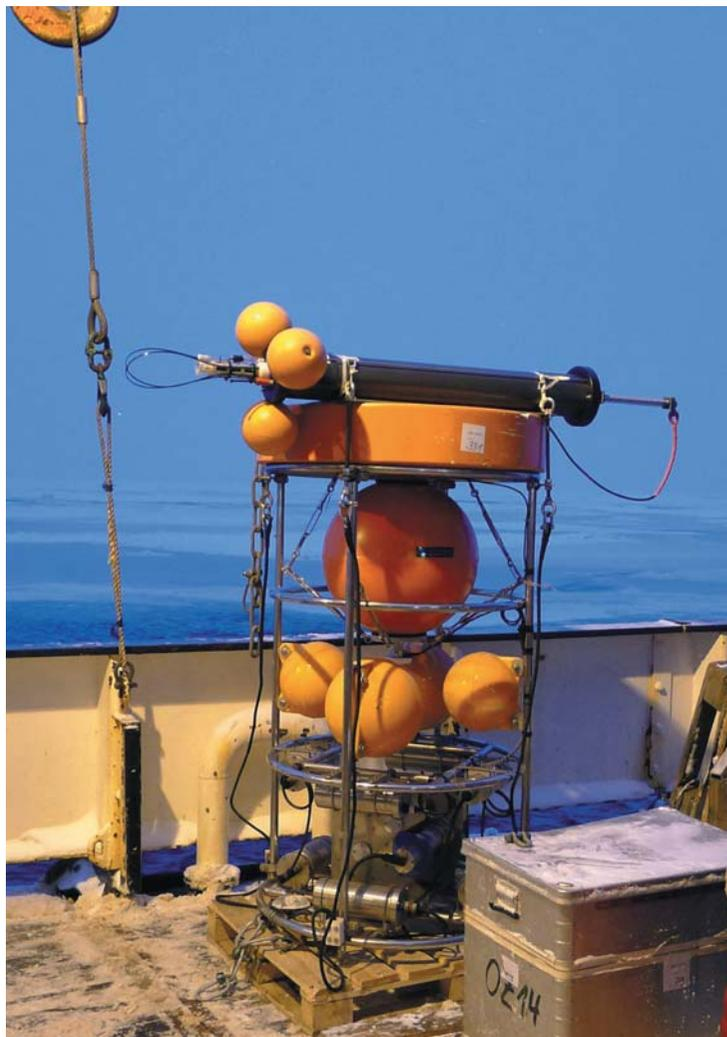
Рис.2. Внешний вид на палубе подводной лебедки, с помощью которой CTD зонд (цилиндр, лежащий горизонтально сверху) периодически производит зондирование от верхнего окончания приотпленной буйковой станции к нижней поверхности дрейфующего льда (фото автора, 2011 год)
