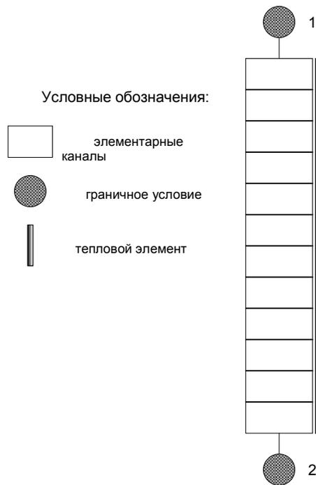
Рис. 8. Нодализационная схема экспериментальной установки с вертикальной трубой
