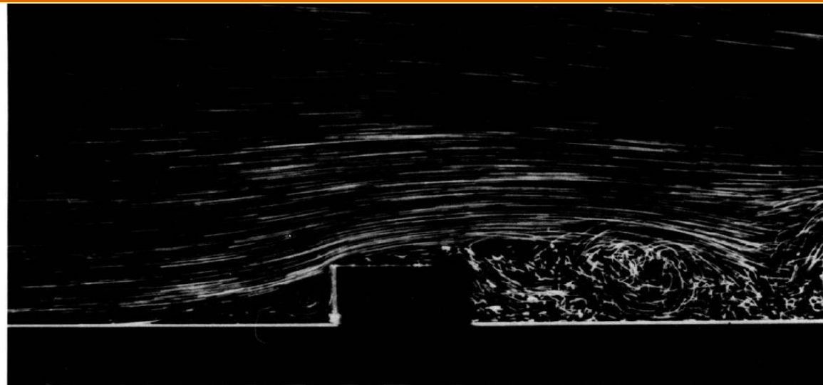
39. Турбулентный отрыв при обтекании прямоугольного выступа на пластинке. Высота выступа велика по сравнению с толщиной набегающего на него ламинарного пограничного слоя. Течение практически плоское, поэтому рециркуляционная
