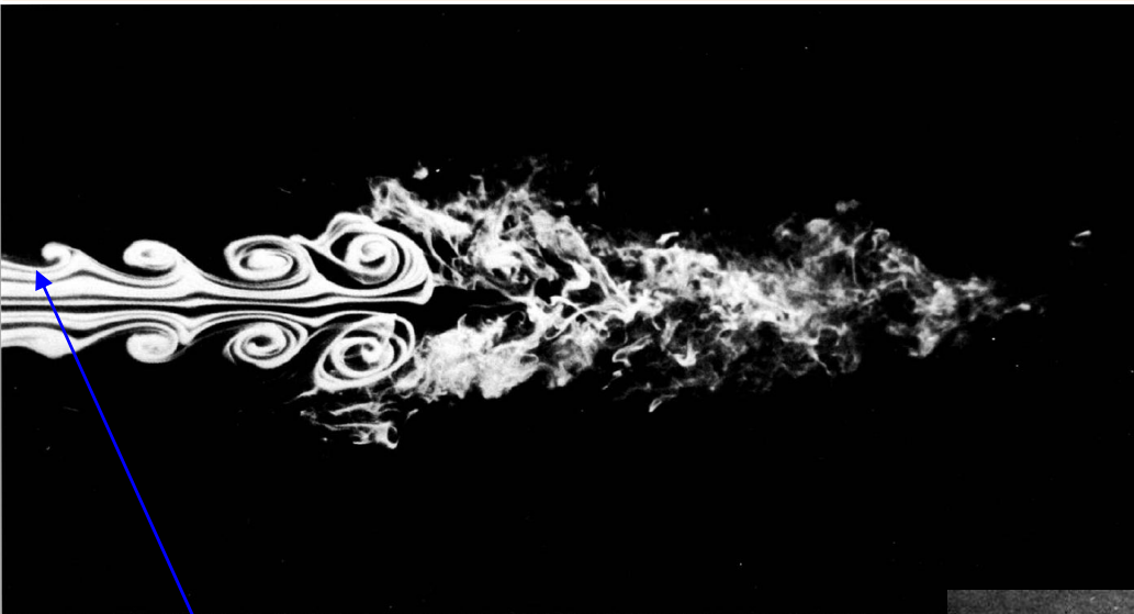
102. Неустойчивость осесимметричной струи. Ламинарный поток воздуха вытекает из круглой трубы при числе Рейнольдса 10 000 и визуализируется с помощью дымовой проволоки. Во внешней области струи развиваются осесимметричные колебания, затем эта область струи превращается в вихревые кольца, после чего струя становится турбулентной. Фото Robert san Nagib
