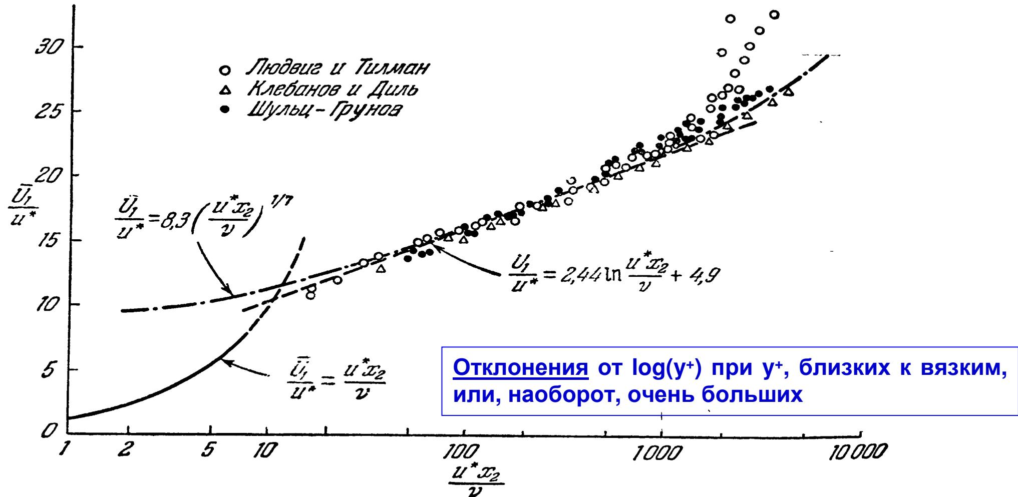
Рис. 7.2. Распределение осредненной скорости вблизи гладкой стенки.
