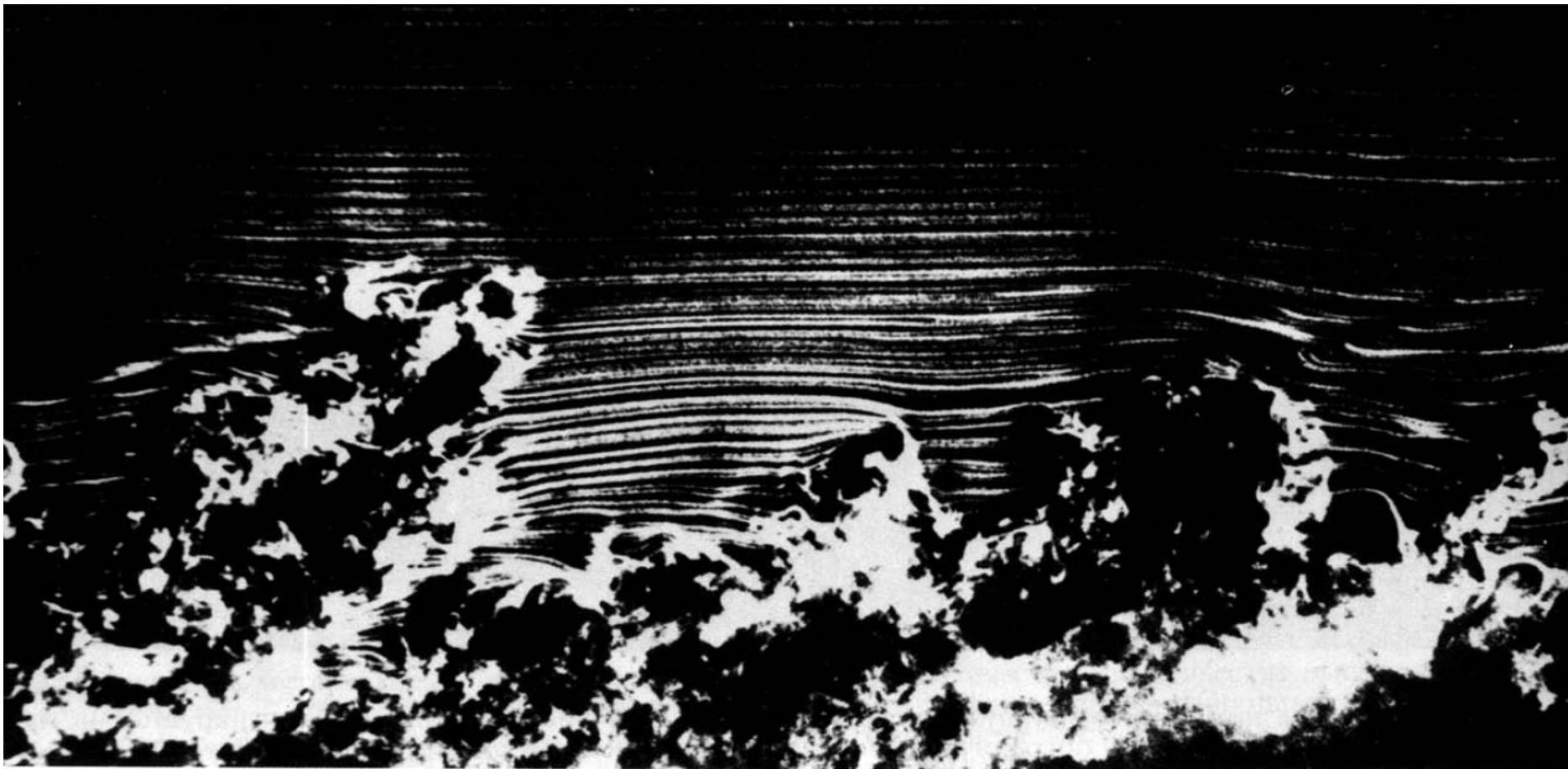
157. Турбулентный пограничный слой, вид сбоку. Здесь турбулентный пограничный слой развивается естественным образом на плоской пластинке длиной 3,3 м, подвешенной в аэродинамической трубе. Линии меченых частиц, идущие от дымовой проволочки, поставленной вблизи острой перед-
