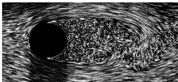
47. Обтекание кругового цилиндра при  $Re = 2000$ . Наиболее чистое потенциальное течение. В передней части этого слой ламинарен, затем он отрывается и разрушается, превращаясь в турбулентный след. Точки отрыва, продолжающиеся вперед по мере возрастания числа Рейнольдса,
