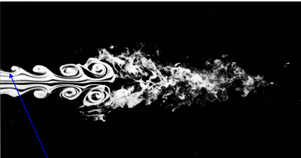
102. Неустойчивость осесимметричной струи. Ламинарный поток воздуха вытекает из круглой трубы при числе Рейнольдса 10 000 и визуализируется с помощью дымовой проволочки. Во внешней области струи развиваются осесимметричные
