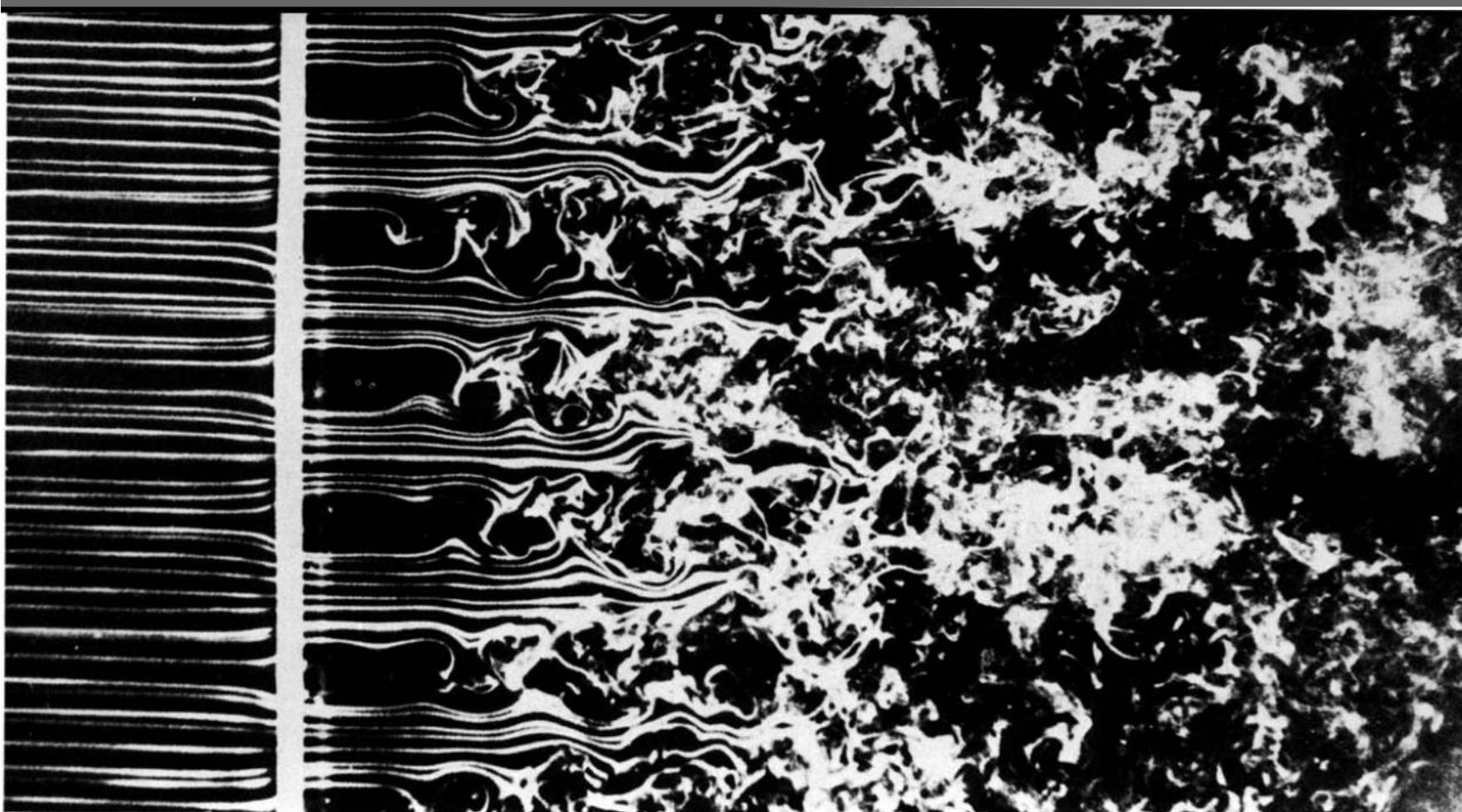
152. Порождение турбулентности решеткой. Дымяевые проволочки демонстрируют прохождение однородного ламинарного потока через пластинку толщиной  $1/16$  дюйма с квадратными перфорациями размером  $3/4$  дюйма. Число Рейнольдса, рас-
