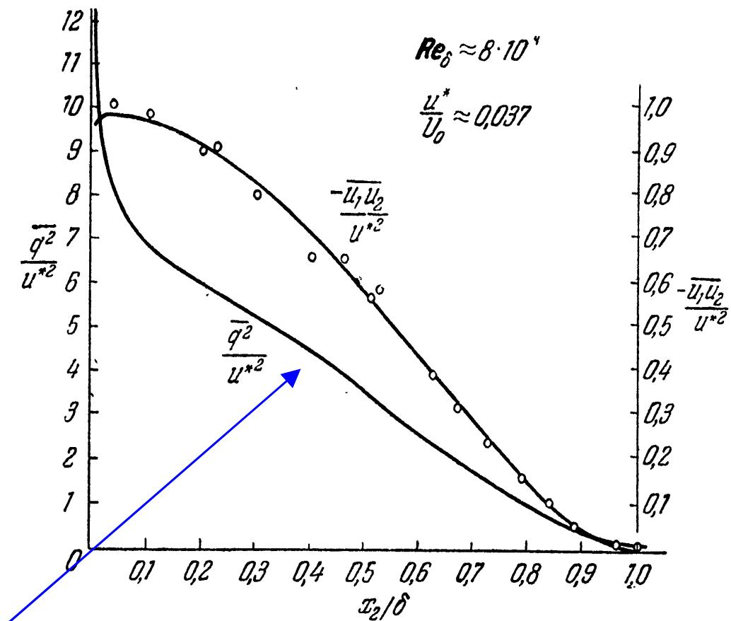
Рис. 7.13. Распределение кинетической энергии турбулентности и турбулентного напряжения сдвига в поперечном сечении пограничного слоя [27].
