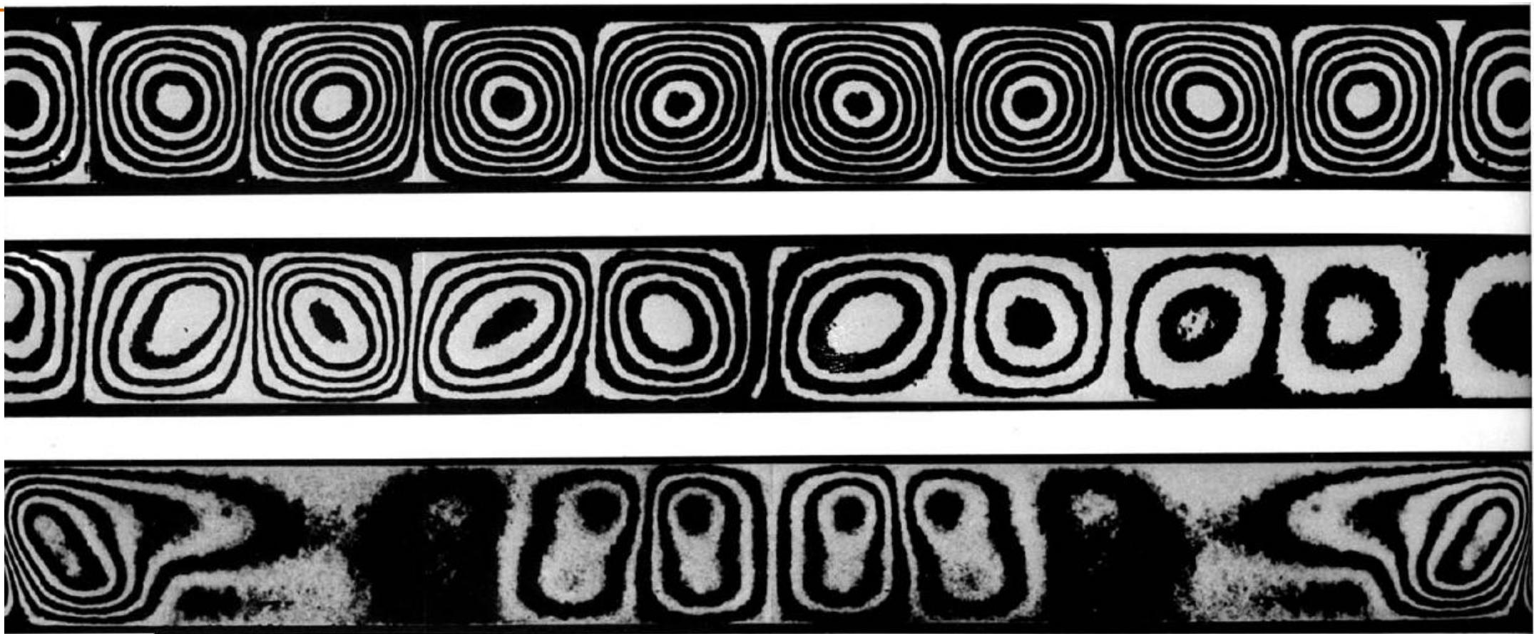
**139. Конвективные валики, движимые плавучестью.** Дифференциальные интерферограммы демонстрируют сбоку картины конвективной неустойчивости силиконового масла в прямоугольном ящике с относительными размерами сторон 10 : 4 : 1, подогреваемом снизу. На верхнем снимке видна классическая ситуация Рэлея – Бенара: рав-
