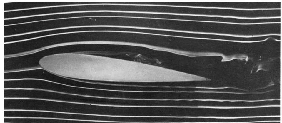
72. Симметричный профиль под углом атаки. Дым в аэродинамической трубе показывает отрыв на верхней поверхности профиля, имеющего относительную толщину 15% и установленного под углом атаки  $6^\circ$ , при числе Рейнольдса 20 000. Фото Peter Bradshaw
