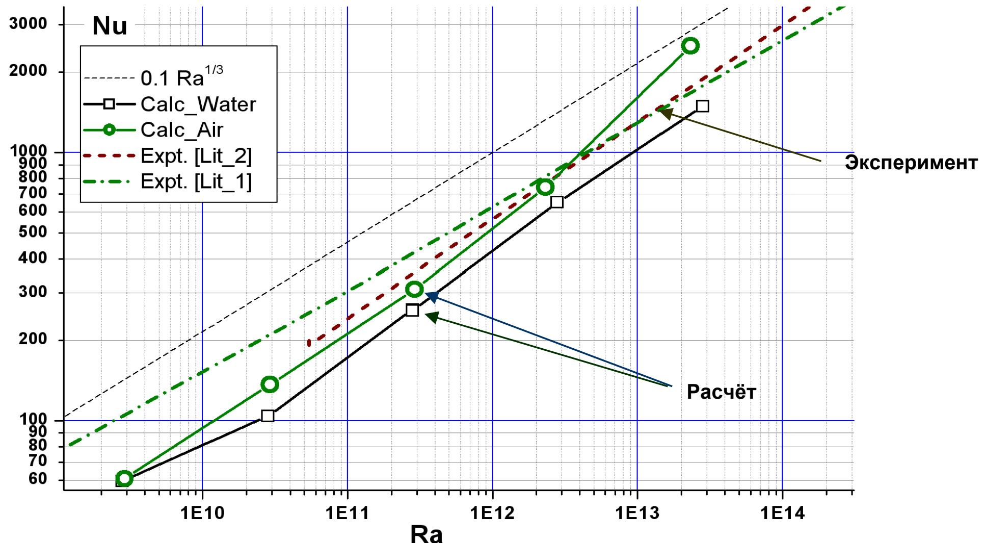
Интегральная теплоотдача при РБК – расчёты для воды (Calc\_Water) и воздуха (Calc\_Air). [Lit\_1]=[42], [Lit\_2]=[43]
