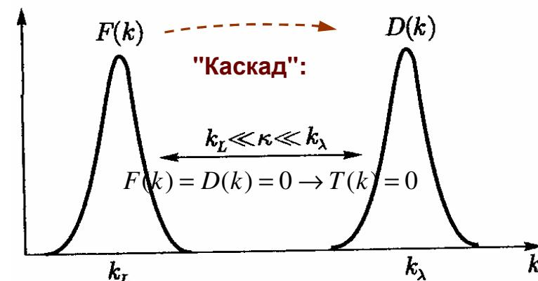
Пульсационная составляющая – в виде  $T(k)$ . На краях график функции  $T(k)$  отвечает  $F(k)$  и  $D(k)$ .
