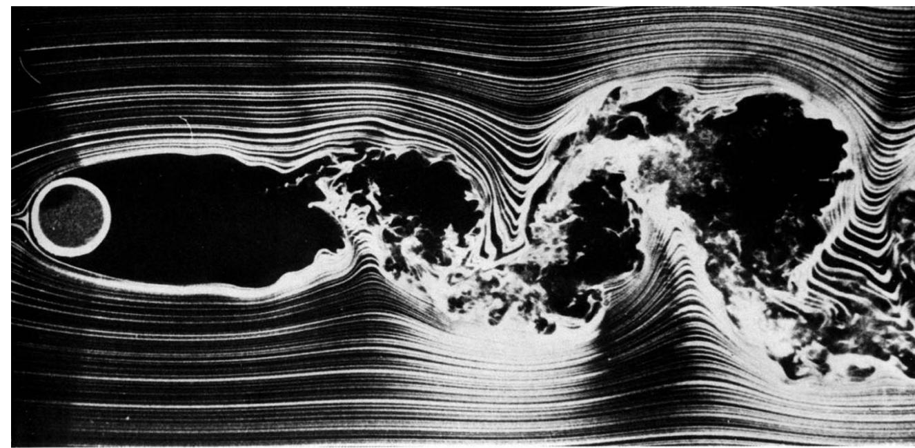
48. Обтекание кругового цилиндра при  $Re = 10\ 000$ . При скорости, в пять раз превышающей скорость потока на предыдущем снимке, картина течения не претерпевает серьезных изменений. Коэффициент сопротивления, следовательно, остается почти по-
