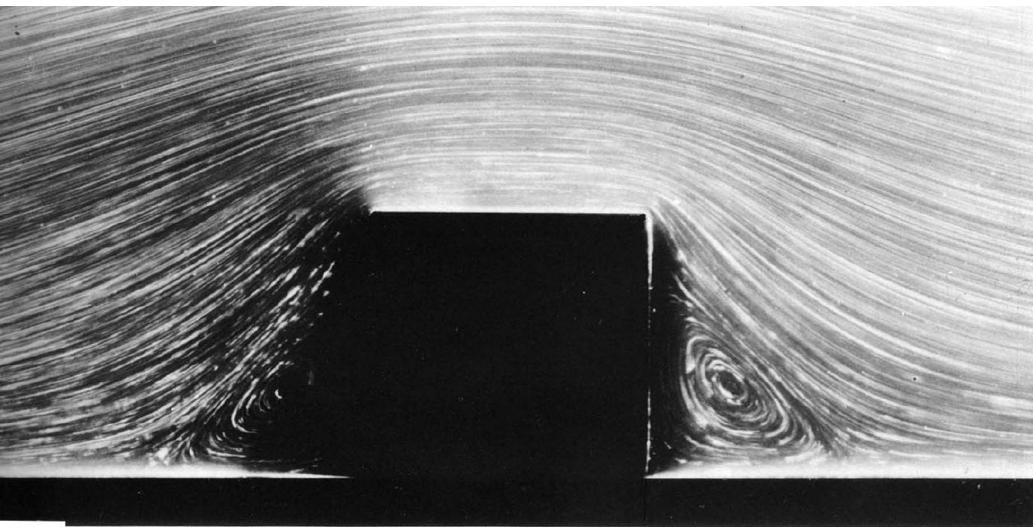
11. Ползущее течение при обтекании квадратного выступа на пластинке. Число Рейнольдса, рассчитанное по стороне квадрата, равно 0,02. В отличие от линий тока безотрывного потенциального обтекания, показанных на фото 5, изображенном здесь плоское течение имеет две области отрыва, которые расположены симметрично спереди выступа
