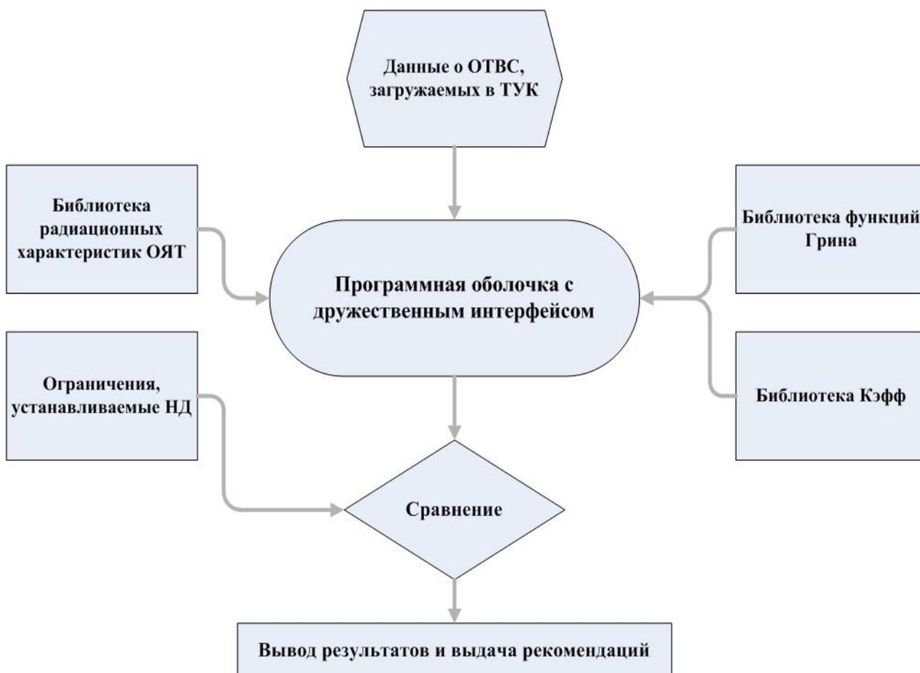
Рисунок 10 – Блок–схема информационной системы поддержки принятия регулирующих решений при транспортировании ОЯТ
