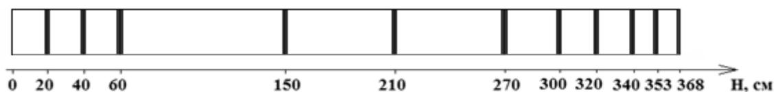
Рисунок 19 – Разбиение топливной части ОТВС по высоте (ТВС–2М)
