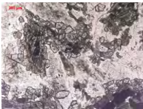
Р-4. Глубина 557 м. Николи «-». Гранат-роговообманковый метадолерит. Мелкозернистый агрегат граната приурочен к контактовым участкам роговой обманки и плагиоклаза
