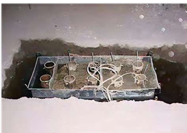
Рис. 4.33. Общий вид исследовательских установок для проведения натуральных исследований миграции радионуклидов
