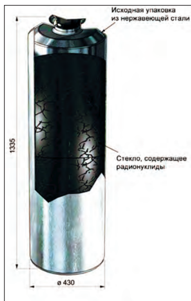
Схема исходного контейнера с остеклованными отходами категории С R7T7
