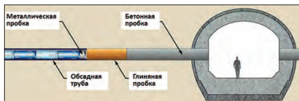
Запечатанная ячейка захоронения отходов категории С
