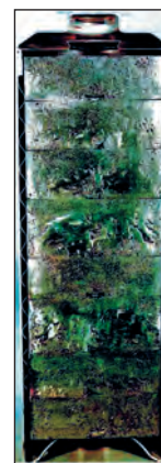
Стандартный контейнер с отходами (CSD-C) в разрезе (модель)
