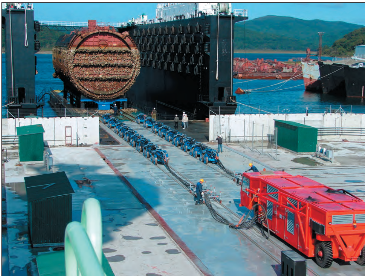
Рис. 4.5.5. Выкатка первого трехотсечного блока лодки зав. № 227 на стапельное место № 1 с помощью немецкого судопоезда, бухта Разбойник, сентябрь 2012 г.
