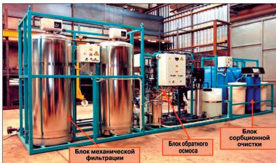
Рис. 4.1.18. Внешний вид стендовой установки очистки НАО
