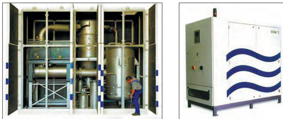
Рис. 6.2.6. Выпарной аппарат с доупаривателем (производительность — 30–5.000 л/ч, концентрирование ЖРО — 0,6–600 г/л)
