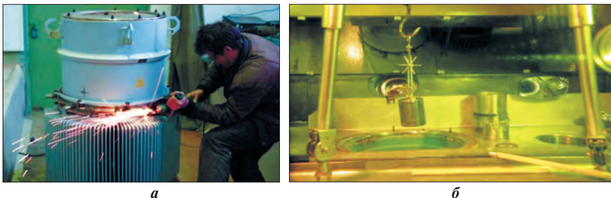
Рис. 4.1.14. Стадии разрядки РИТЭГа: а — начальная; б — завершающая
