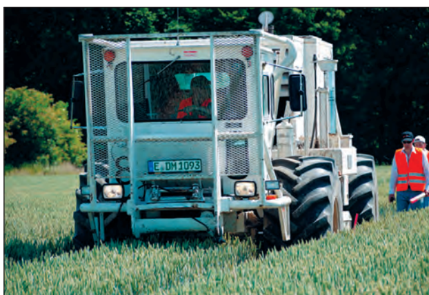
Вибрационные сейсмические источники на геофизической разведке
