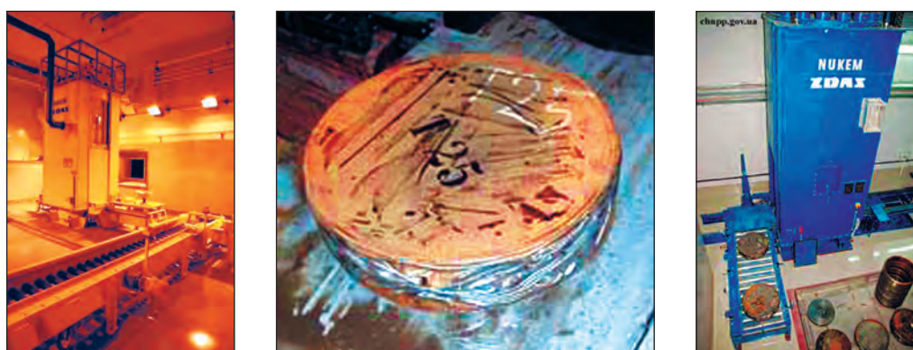
Рис. 6.2.2. Суперкомпактор. Установка для суперпресования ТРО
