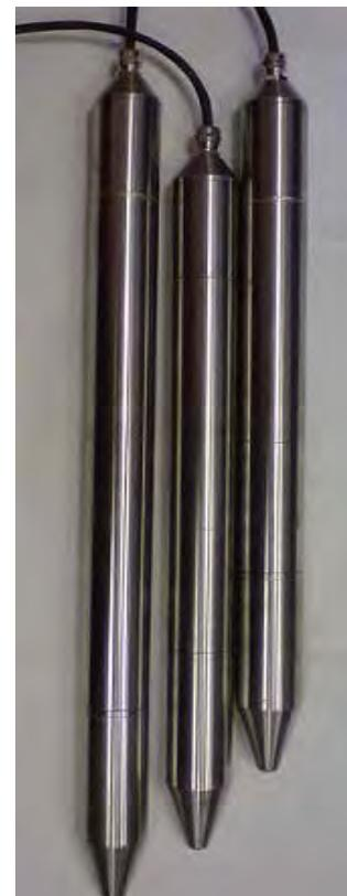
Электромеханическое устройство сканирования "Сканер-ЭУС" (слева), блоки детектирования фотонов, тепловых и быстрых нейтронов (справа). ПАК разработан по ТЗ ОАО «ОДЦ УГР», которое создано не только для решения задач ВЭ реакторного завода СХК, но и для решения аналогичных задач в целом по всей атомной отрасли России.
