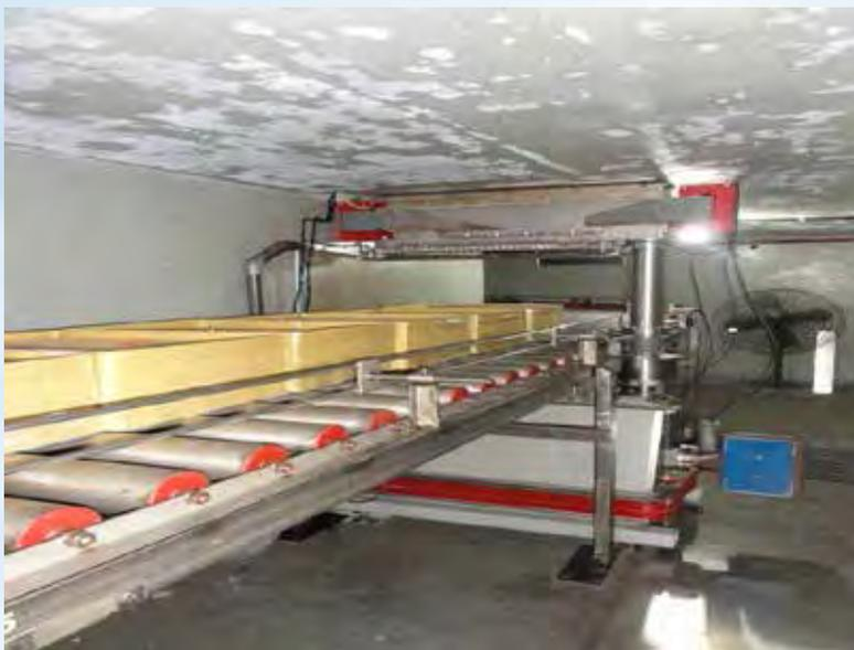
**Общий вид радиационной установки конвейерного типа на основе линейного ускорителя электронов с энергией 10 МэВ (Демский и др., 2013)**
