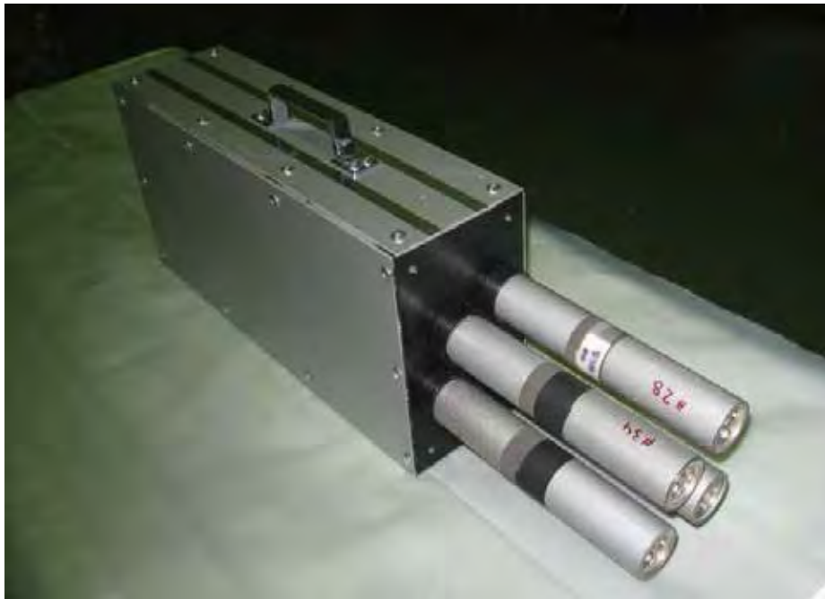
Активационный детектор импульсного нейтронного излучения
