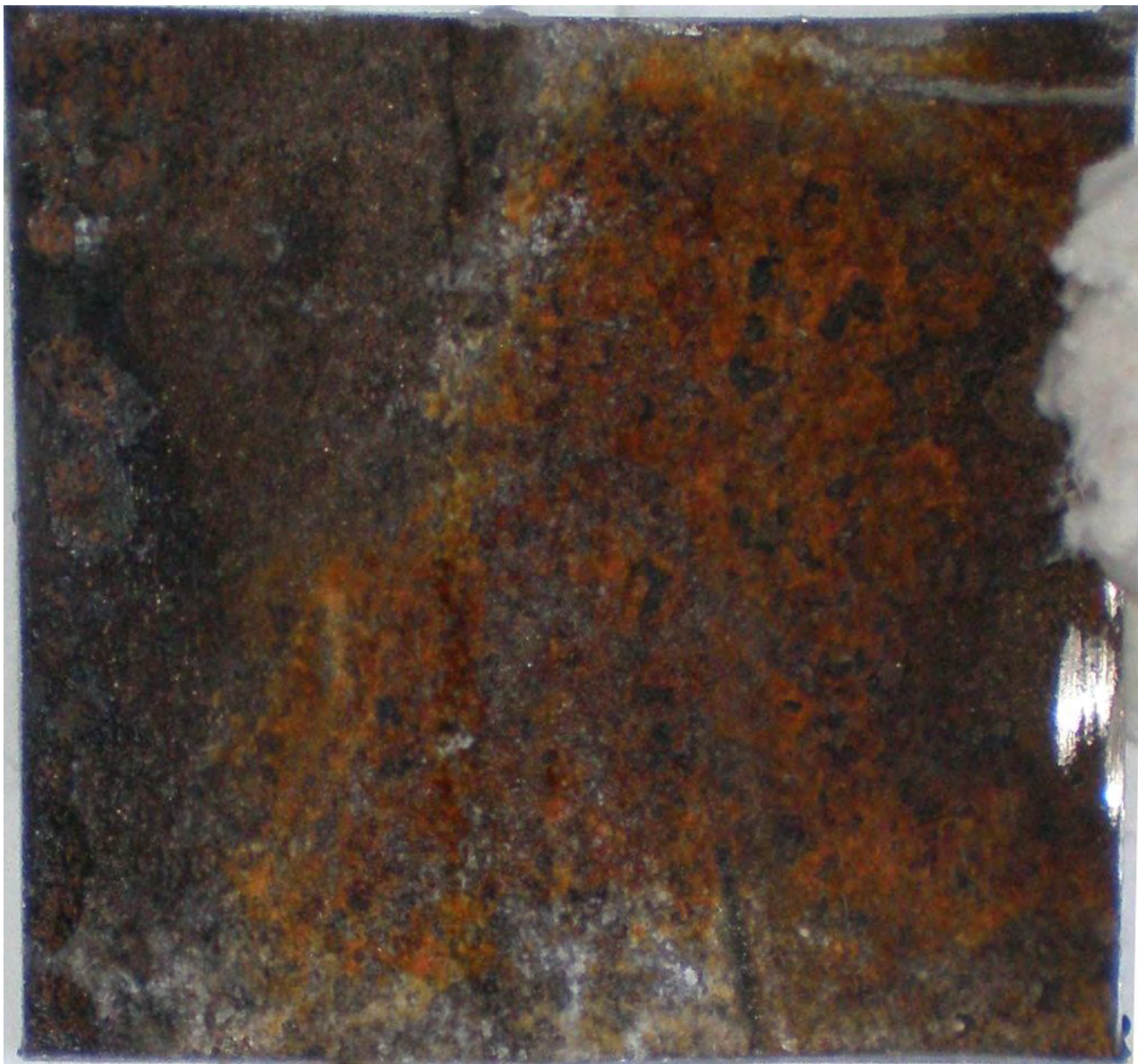
Наружная поверхность темплета №2 (тип Б) после протирки тампоном с водой
