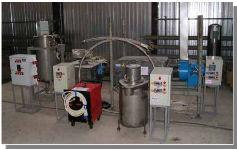
Установка кондиционирования отработавших источников ионизирующего излучения «Москит-Т»
