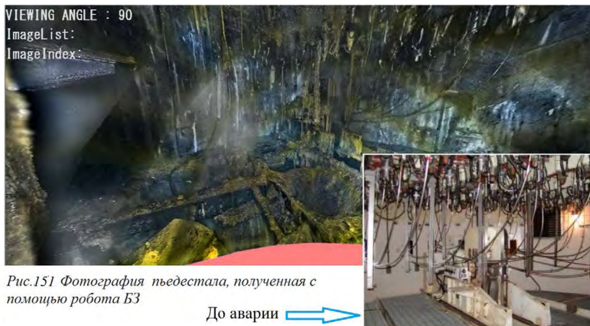
Рис.150. Фотографии, полученные с помощью робота БЗ, внутри контейнмента 2-го блока (подробнее см. выше).
