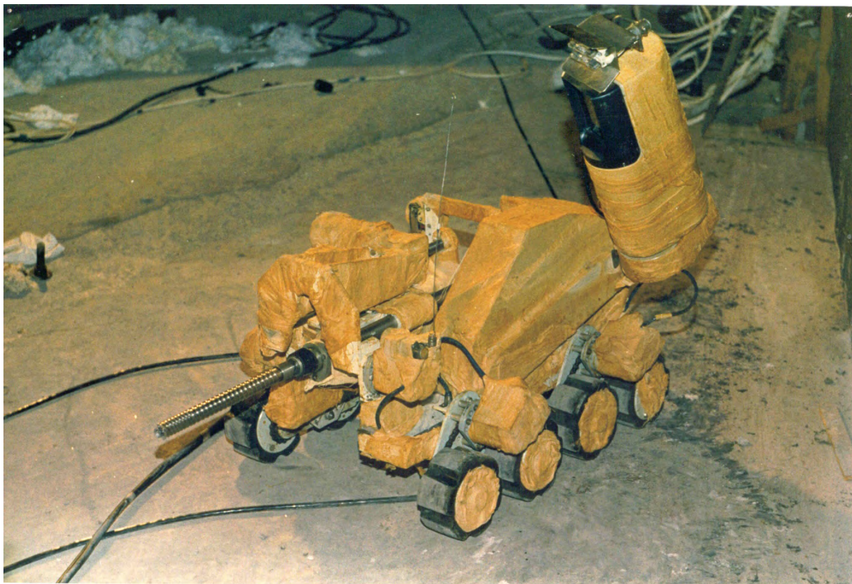
Рис.50. Робот, сконструированный в КИ. Специальное покрытие предохраняет его внутренние детали от запыления.
