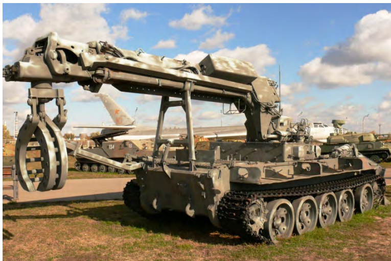
Рис.27. Инженерная машина разграждения.
