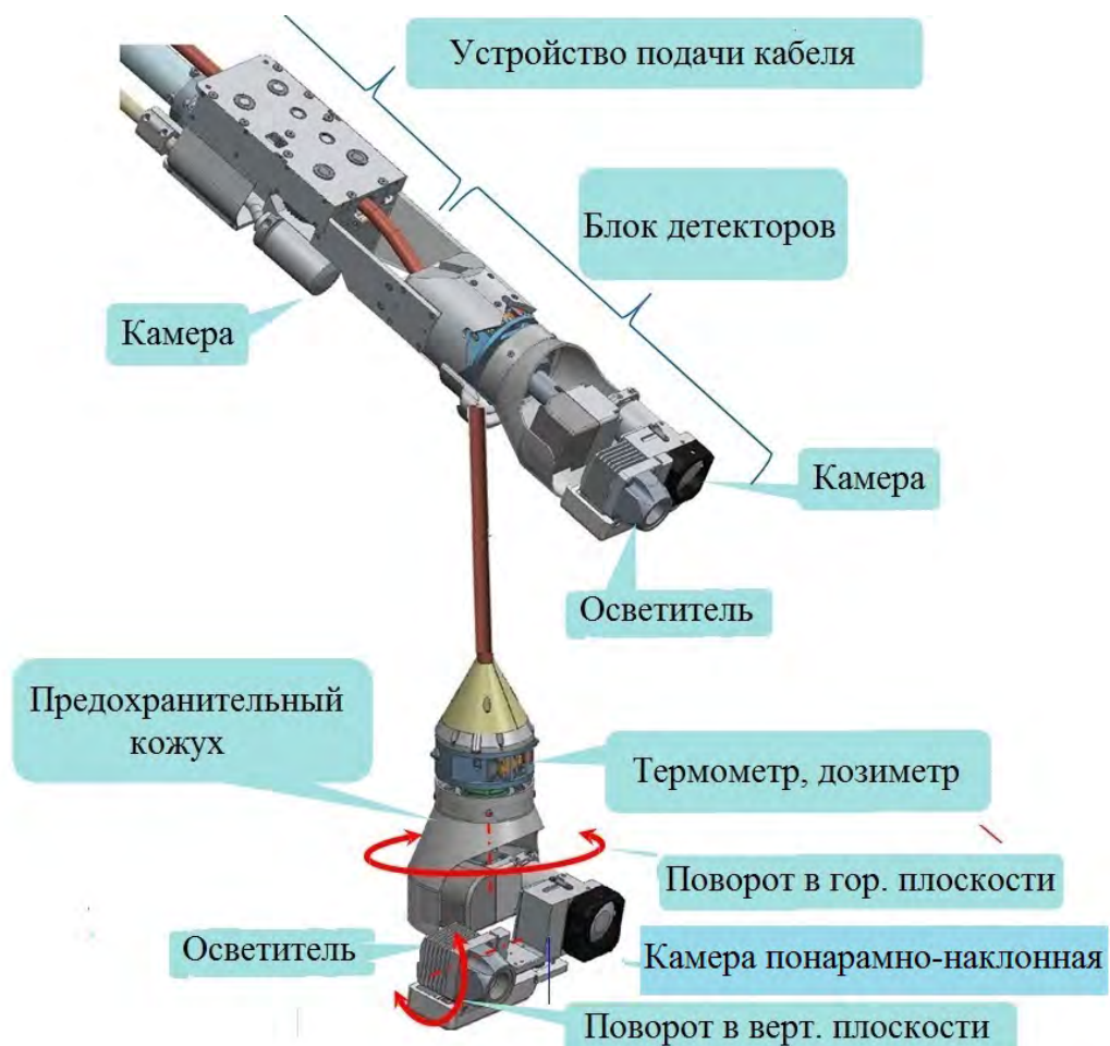
Рис. 148. Измерительный модуль, находящийся в головной части «Большой змеи».
