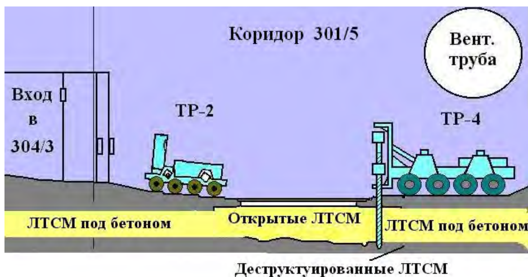
Рис. 56. Схема работ по исследованию ЛТСМ и бетона в коридоре 301/5 с помощью ТР-4 (проводил бурение и отбор проб) и ТР-2 (осуществлял корректировку работы первого робота).
