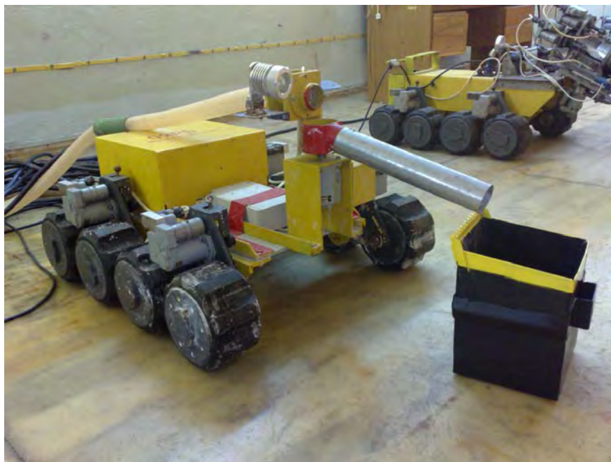
Рис. 80. Модернизированный дистанционно управляемый самоходный агрегат для заливки ЭКОР в лаборатории.
