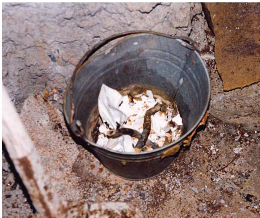
Рис. 26. Части твэлов, собранные на площадке вентиляционной трубы.
