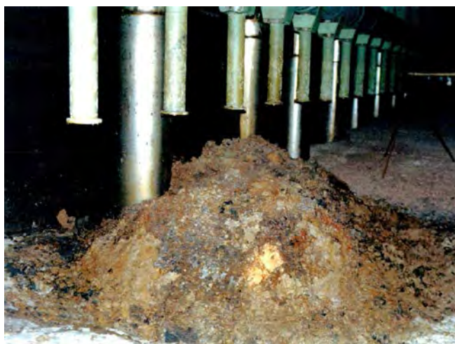
Рис. 81. Скопление ЛТСМ на первом этаже бассейна-барботера («куча») до нанесения покрытия. Справа на схеме расположение скопления в пом.012/7 и величины МЭД (Р/час) на ее поверхности, измеренные в 1989г.
