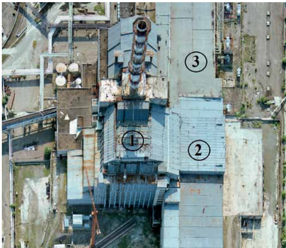
Объект «Укрытие». Начало 1987 г. (аэросъёмка). 1 — сам объект «Укрытие». Размеры этого сооружения: основание — 260 м на 165 м, высота — 110 м (как ~ 30-этажный дом) 2 — часть новой кровли машзала 4-го блока, 3 — часть новой кровли машзала 3-го блока (к моему приезду в 1987 г. её ещё не было)
