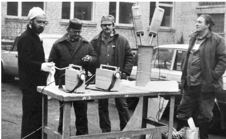
Сотрудники Радиевого института им. В.Г. Хлопина в процессе сличения методов отбора воздуха воздухозаборниками различных конструкций, оснащенных различными фильтрами. Октябрь 1986 г.
