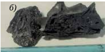
Образец коричневой (а) и черной (б) «лавы». Чёрная «лава» на полу одного из помещений «Укрытия» (в)
