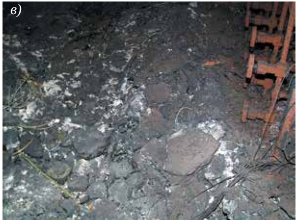
Образец коричневой (а) и черной (б) «лавы». Чёрная «лава» на полу одного из помещений «Укрытия» (в)
