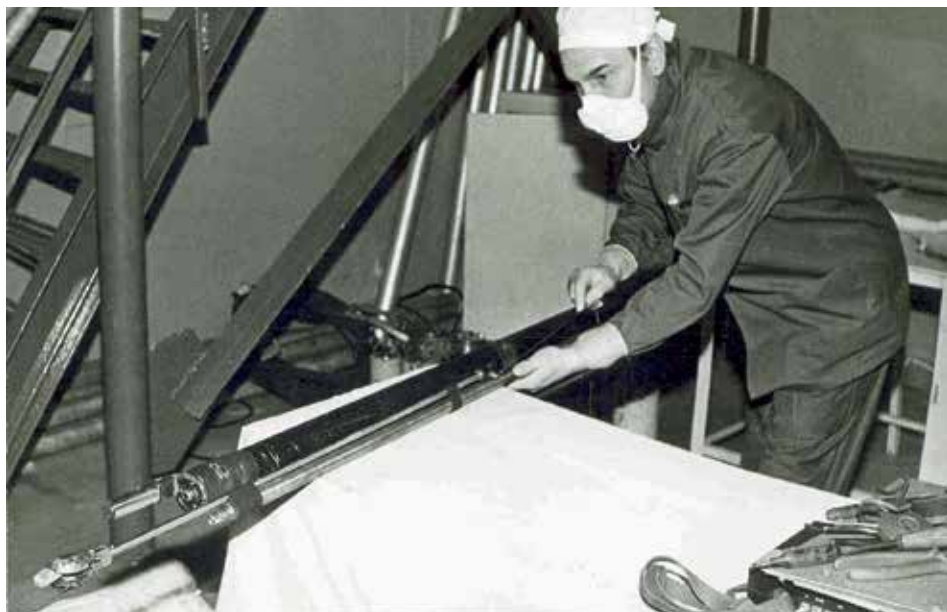
Щуп с видеокамерой для наблюдения с помощью скважины
