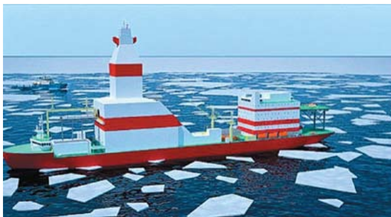
Рис. 11. Проект бурового судна для арктического шельфа «Крыловского государственного научного центра»
