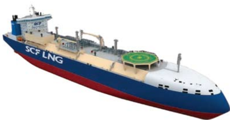
Рис. 19. Концептуальный проект газовоза для перевозки сжиженного природного газа с арктических месторождений России
