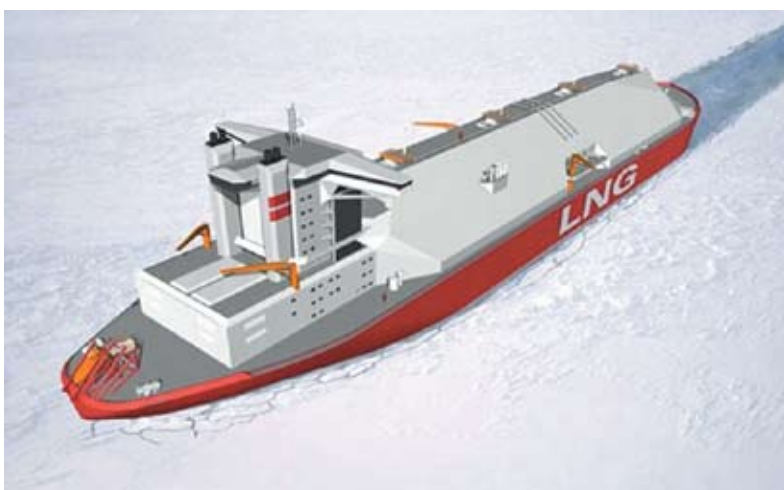
Рис. 22. Концепция СПГ-танкеров для Арктики. Технология DA (Double Acting)
